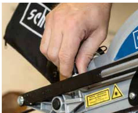
+ VORWAHL: Ein Tiefenanschlag ist stets vorhanden – leider meist ohne Skala.
