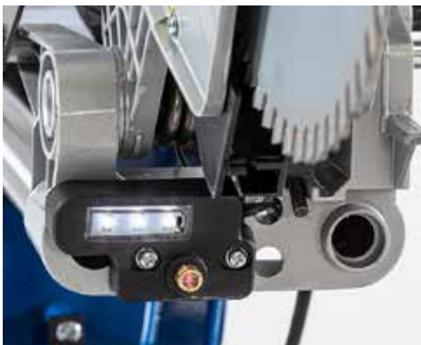
- DOPPELT: Licht und Laser sind nur gemeinsam schaltbar (Scheppach 1440L).
