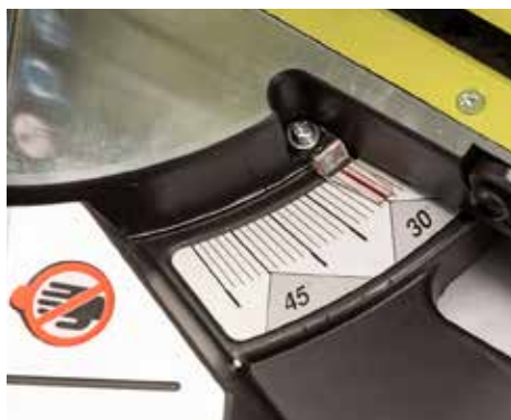
+ HINTERSCHNITT: Bei Ryobi reicht der Schwenkbereich der Säge über 45 Grad.
