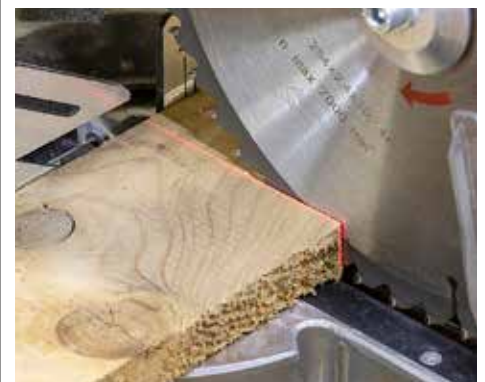
+ GENAU: Hier erlaubt der Laser eine exakte Kontrolle des Schnitts ( Metabo ).
