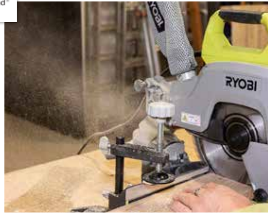
- NUTZLOS: Der an allen Geräten vorgesehene Weg der Staubsammlung in einem Stoffsack ist durchgehend nahezu wirkungslos.
