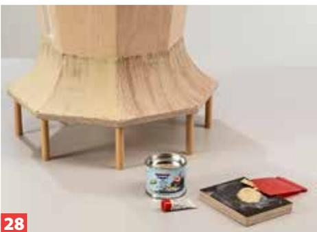
**28** Nach dem Trocknen und einem Grobschliff verspachteln Sie den gesamten Übergang mit 2-Komponenten-Spachtelmasse.
