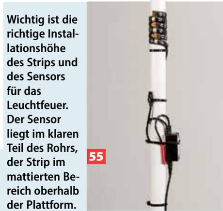
**55** Wichtig ist die richtige Installationshöhe des Strips und des Sensors für das Leuchtfeuer. Der Sensor liegt im klaren Teil des Rohrs, der Strip im matten Bereich oberhalb der Plattform.
