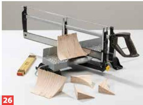
**26** ... einfacher haben Sie es später mit dem Spachteln und Schleifen. Diese Bauteile schneiden Sie dann mit der Gehrungssäge ...
