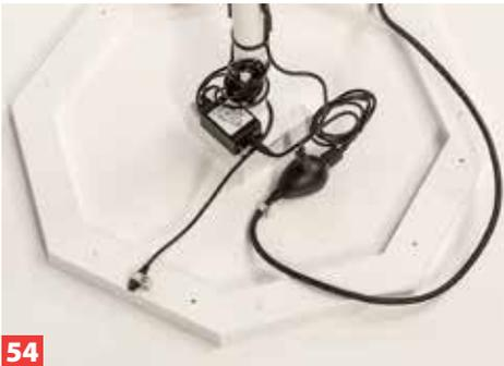
**54** Nach dem Lackieren die Strips, die Steuergeräte und die USB-Hub-Verlängerung sowie den Sensor auf dem Leistenrand montieren.
