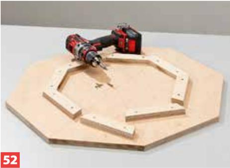
**52** Dann geht es an die Grundplatte: Das Achteck zuschneiden und den innenliegenden Leistenkranz für den Turm festschrauben.
