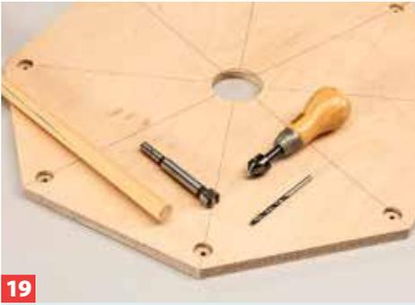
**19** In die Ecken Zapfensenkungen für die Geländerpfosten bohren und von der Unterseite für die Schraubenköpfe senken.
