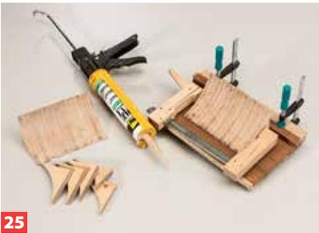
**25** Jeweils 10 der insgesamt 80 Platten verkleben Sie bündig in einer Lade zu acht Bauteilen. Je genauer Sie arbeiten, desto ...
