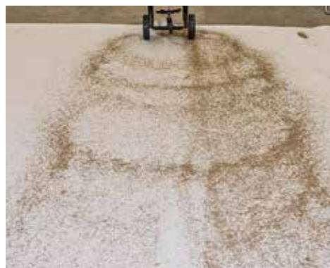
UNGENAU: Mit dem Dema-Streuer fällt eine gleichmäßige Ausbringung schwer.
