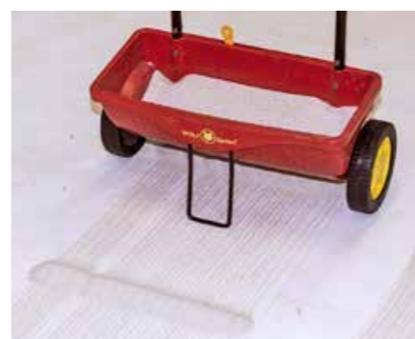
ÜBERDOSIERT: Trotz Stopp rieselt feines Material durch – hier bei Wolf.
