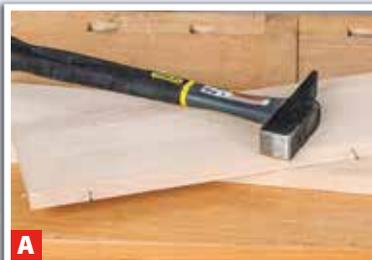
**A** Treiben Sie dünne Drahtstifte in eine der beiden Leimflächen. Schon zwei Nägel bieten später sicheren Halt.
