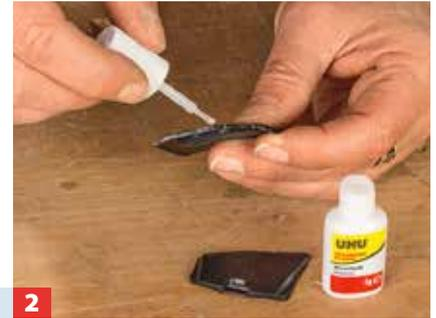
**2** Ist der Reparaturbereich etwas größer, kann die Klebestelle gut mit einem Pinsel gleichmäßig benetzt werden.
