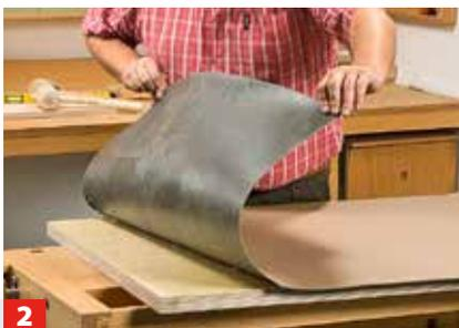
**2** ... nach außen arbeiten, Ränder satt einstreichen! Nach der Abluftzeit die Werkstücke passgenau zusammenbringen. Eine Korrektur ...
