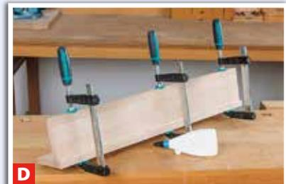
**D** ... bohren sich ins Holz. Beim Pressen verhindern die Drahtspitzen, dass sich die Bauteile verschieben.
