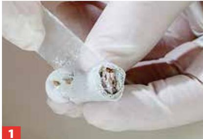
**1** Verpackung öffnen, mit einem feuchten Messer benötigte Portion abteilen, nicht benötigte Knete wieder einpacken.
