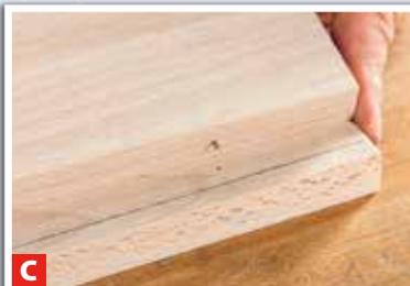
**C** Fügen Sie die beiden Holzteile exakt so zusammen, wie sie verleimt werden sollen. Die Drahtspitzen ...
