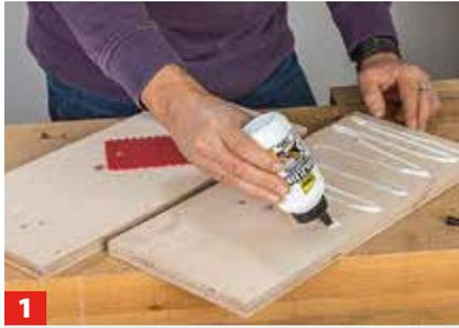
**1** Ausreichend Holzleim auftragen, um eine dünne geschlossene Leimschicht auf dem Werkstück erreichen zu können.
