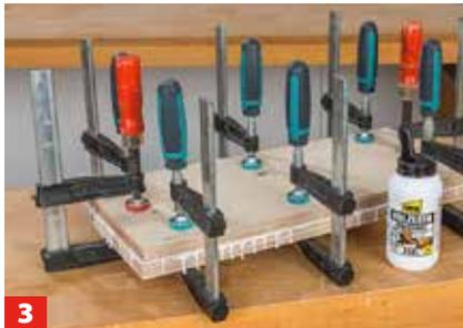
**3** Werkstücke zusammenfügen und auf ganzer Leimfläche möglichst gleichmäßig verzwingen. Leim soll seitlich austreten.
