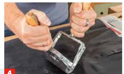
Die Verklebung wird unmittelbar danach möglichst stark zusammengepresst. Eine Fixierung der Verklebung ist nicht nötig.
