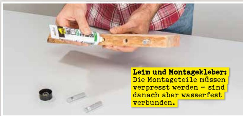
**Leim und Montagekleber:** Die Montageteile müssen verpresst werden – sind danach aber wasserfest verbunden.
