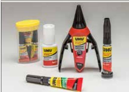
**Flüssig-Kleber:** Cyanacrylat-Klebstoffe sind typischerweise sehr dünnflüssig und durchsichtig. Dadurch können sie auch in enge Risse eingebracht werden und verteilen sich gut in der Klebefuge. Sekundenkleber sind generell nicht spaltüberbrückend – daher müssen die zu verklebenden Teile exakt zueinanderpassen. Ideal ist dabei eine Luftfeuchtigkeit zwischen 50 und 70 Prozent.
