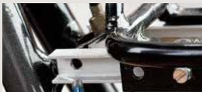
Ein Tropfen Schraubensicherung am Gewinde fixiert metrische Schrauben und hält auch bei Belastung durch Vibration.
