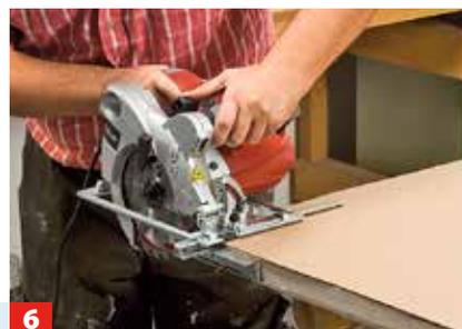
**6** Durch Verkleben beschichtete Platten können alternativ nach dem Klebevorgang besäumt werden.
