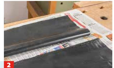
... zunächst mit dem Klebstoff benetzt und lüften dann bis zur oberflächlichen Trocknung des Klebstoffs ab.
