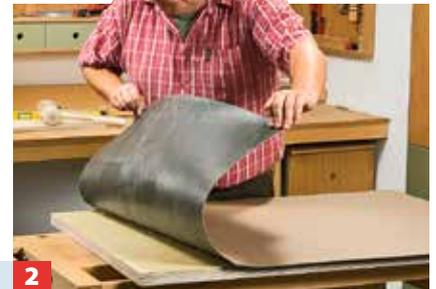
... und ablüften lassen. Ist die Klebeschicht berührungstrocken (nach rund 10 Minuten), Teile zusammenfügen.
