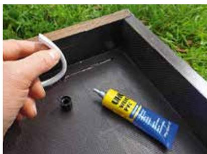
Montage einer Dichtung: Klebstoff einseitig auftragen und ablüften lassen. Dann erst das Werkstück aufdrücken.
