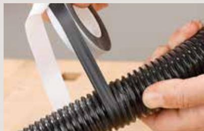
Das Reparaturband (hier *UHU Repair all Pannenband*) mehrfach straff und überlappend über die Schadstelle wickeln.
