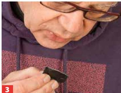
**3** Bei trockener Umgebungsluft können Sie eine der Verbindungsstellen anhauchen, um Feuchtigkeit für die Reaktion ...
