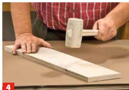
**4** ... Klüpfel oder Gummihammer bearbeiten, die Fläche mit einer Zulage möglichst gleichmäßig bearbeiten. Für die Haftung ...
