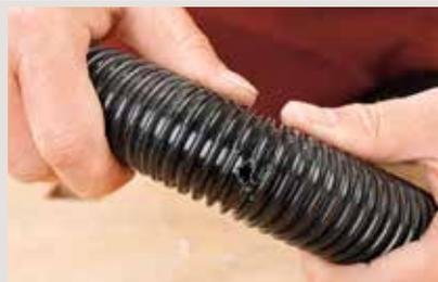
Beschädigte Schläuche und Isolierungen können Sie mit selbstverschweißendem Reparaturband verschließen.
