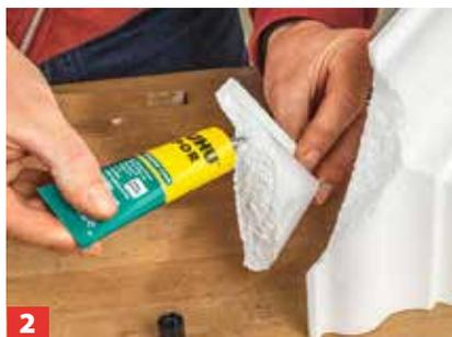
... beidseitig auf. Die Klebeschicht dann ablüften lassen, bis die Oberfläche nicht mehr klebrig ist (nach ...
