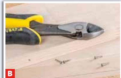
**B** Kneifen Sie die Drahtstifte nah an der Holzoberfläche mit einem scharfen Seitenschneider ab.
