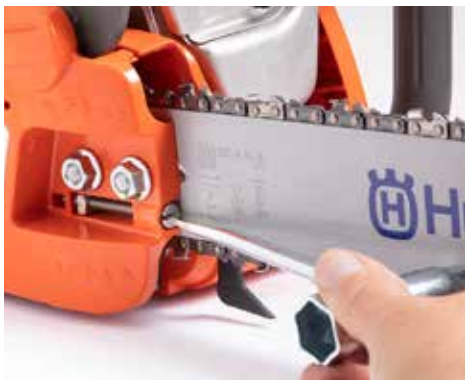
- UNBEQUEM: Bei Husqvarna ist die Ketten-Spannschraube vorn angeordnet.
