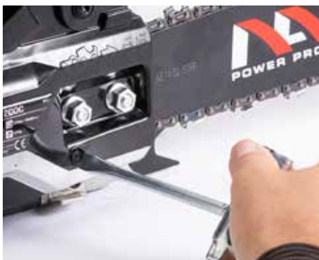
+ PRAKTIKABEL: Bei Nax wird mit einer gut erreichbaren Schraube gespannt.
