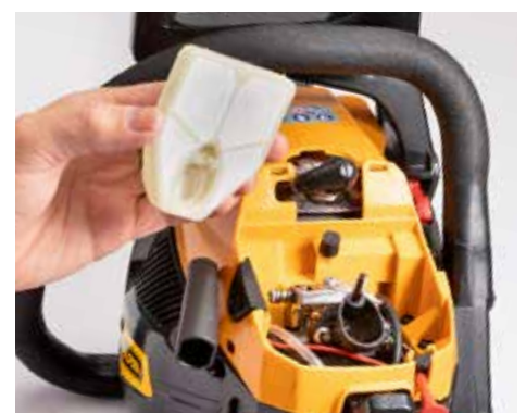
+ EINFACH: Luftfilter und Zündkerze sind gut zugänglich (hier bei Alpina ).
