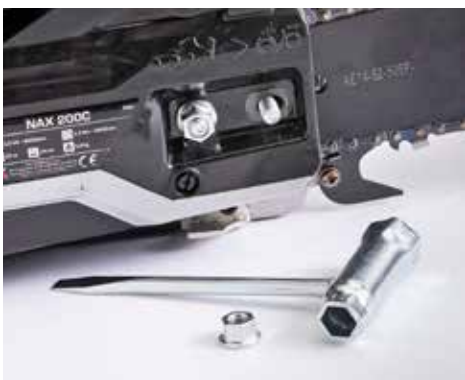
- VERLIERBAR: Bei der Nax -Maschine sind diese Schrauben schnell verloren.
