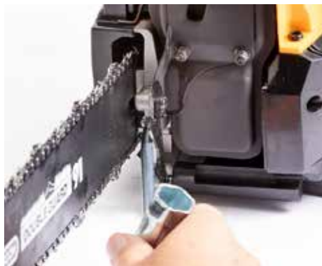
- LÄSTIG: Bei Atika ist die Spannschraube hinter dem Kettenblatt versteckt.
