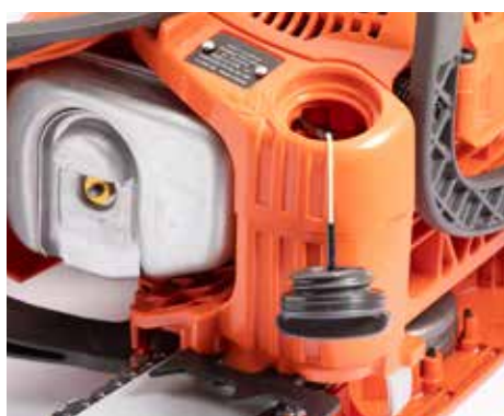
+ SICHERUNG: Bei allen Sägen (hier Husqvarna ) sind die Tankdeckel gesichert.
