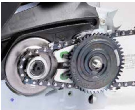
+ PRAKTISCH: Bei Stihl verläuft die Kette auf dem Antriebsritzel gut zugänglich.
