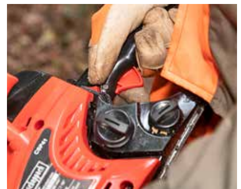
- AUS: Unter anderem bei Schepach wird der Betriebsschalter ungewollt betätigt.
