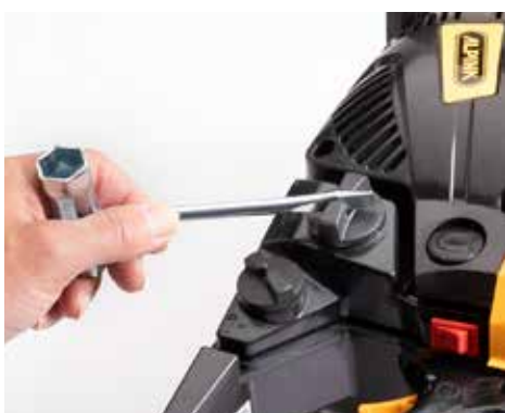
+ LEICHT: Hier kann der Tank notfalls mit dem Kettenschlüssel geöffnet werden.
