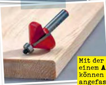
Mit der Oberfräse und einem **Anlauf-Kegelfräser** können Werkstückkanten angefast werden.
