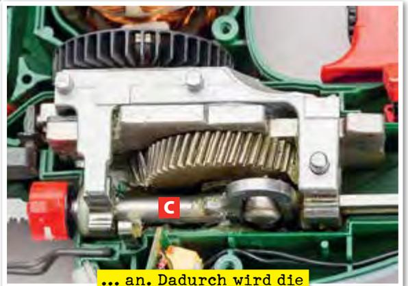
... an. Dadurch wird die **Hubstange C** auf und ab bewegt – hier gezeigt die beiden Extrempositionen der Hubbewegung.
