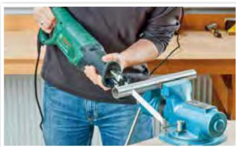
**ZUSCHNITT WERKSTÜCK:** Durch den vergleichsweise großen Hub können verschiedene Werkstoffe schnell getrennt werden.
