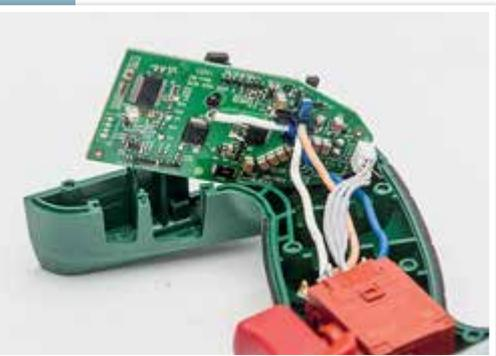
... die Stromzufuhr ab. Meist wird hier auch die Drehzahl der Maschine geregelt.
