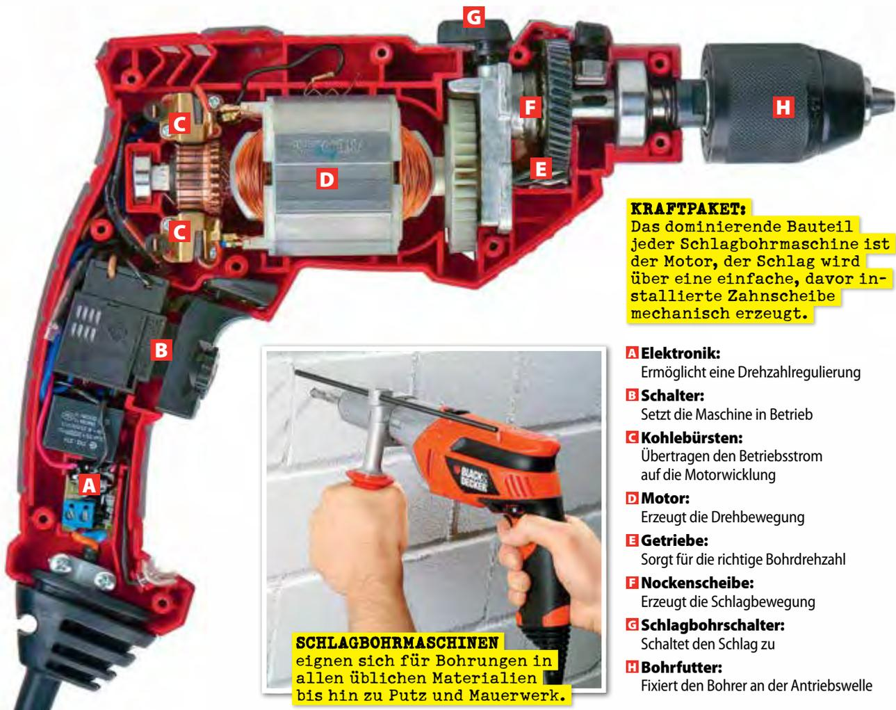
**KRAFTPAKET:** Das dominierende Bauteil jeder Schlagbohrmaschine ist der Motor, der Schlag wird über eine einfache, davor installierte Zahnscheibe mechanisch erzeugt.
