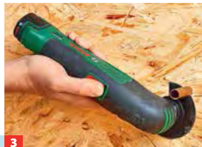
3 Der Einsatzbereich dieser Maschine ist sehr groß – zum Beispiel können Rohre flächenbündig gekürzt werden.
