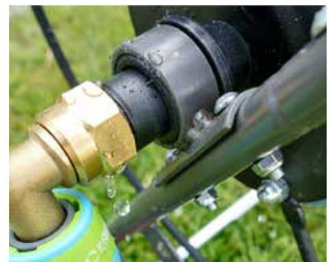
**- UNDICHT:** Der *Sirocco*-Wagen leckt schon bei üblichem Wasserdruck.
