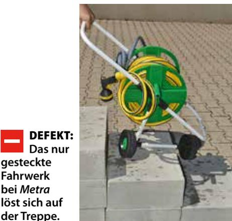
**- DEFEKT:** Das nur gesteckte Fahrwerk bei *Metra* löst sich auf der Treppe.
