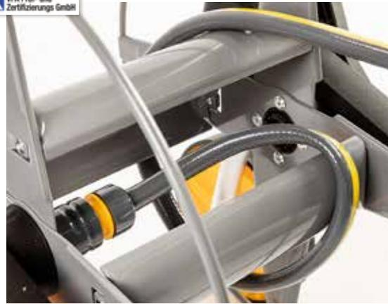
**- KNICKT:** Bei *Nep-tun* kann der Schlauch an der Trommel gequetscht werden – dann läuft bei teilweise aufgerolltem Schlauch weniger Wasser.
