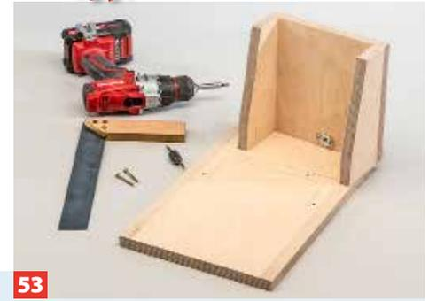
**53** Im Anschluss wird die Grundplatte mit der Liftplatte verschraubt. Die Platten exakt ausrichten und die Schrauben sorgfältig senken.
