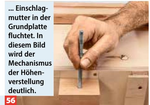
... Einschlagmutter in der Grundplatte fluchtet. In diesem Bild wird der Mechanismus der Höhenverstellung deutlich.
