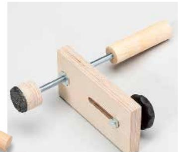
**D** **SCHRAUBZWINGE:** Sie spannt von vorne Bauteile gegen Bankhaken in der Werkplatte fest.
