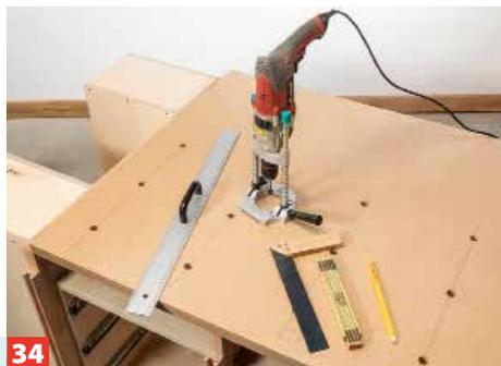
**34** Markieren und bohren Sie im Hohlbereich über den Schubkastenschränken die Positionen der 20-mm-Niederhalter-Löcher.
