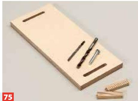
**75** ... Sägeschnitt in einem glatten Maß vom Rand entfernt. Angeschlagen wird die Schiene mit einer solchen verstellbaren Platte.
