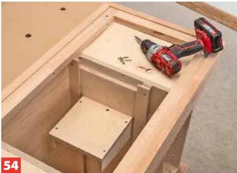
**54** Der Lift wird nun in den Fräs-Unterschrank eingebaut. Dabei werden lediglich die beiden Schienen mit dem Korpus verschraubt.
