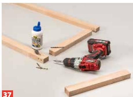
**37** Verleimen und verschrauben Sie nun den Auflagerahmen für die Fräsplatte. Die Rahmenhöhe ist so bemessen, dass sie mit ...
