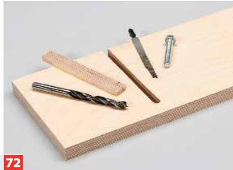
**72** Die Grundplatte erhält zusätzlich im Achsmaß der Verstellerschrauben in der Grundplatte zwei Schlitz für M8er Schrauben.
