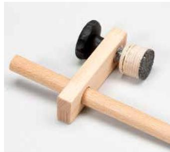
**C** **NIEDERHALTER:** Fixiert Werkstücke durch Verkleben in den Löchern auf der Arbeitsplatte.
