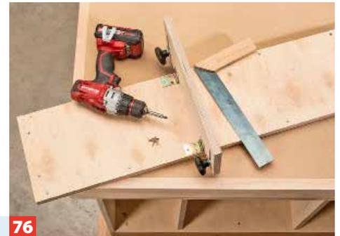
**76** Sie wird mit Scharnieren klappbar und rechtwinklig unter die Schiene geschraubt und in der Nut-Schiene befestigt.
