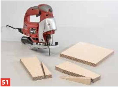
**51** Die Grundplatte wird mit zwei seitlichen Konsolen gestützt. Schneiden Sie sie zu ...
