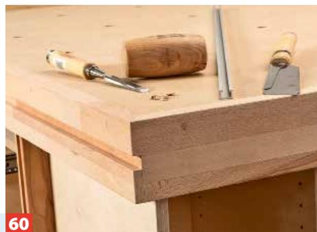
**60** Bei der Arbeitsplatte werden jetzt die Nut-Profile montiert. Dazu die Rahmenecken mit einem scharfen Beitel sauber ausstemmen.
