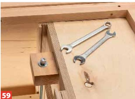
**59** Die Gewindestange von oben in die Einschlagmutter drehen. Eine Unterlegscheibe auflegen und zwei Muttern sicher kontern.
