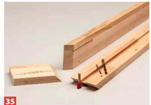
**35** Die Deckelplatte erhält einen hohen Buchenholz-Rahmen. Der Schubkastenseitige Rahmen wird für das Alu-Profil genutzt.
