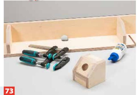
**73** Verleimen Sie nun den Fräsanschlag mit den Winkelplatten. Parallel den Absaugkasten herstellen und ebenfalls aufleimen.
