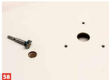
**58** Bohren Sie an dieser Stelle das Loch für das Verstellwerkzeug. Hier müssen Sie eine 13er Nuss mit Luft einstecken können.
