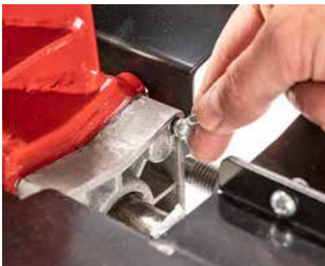
BELÜFTUNG: Nicht immer ist die Lüftungsschraube so gut zugänglich (Al-Ko).
