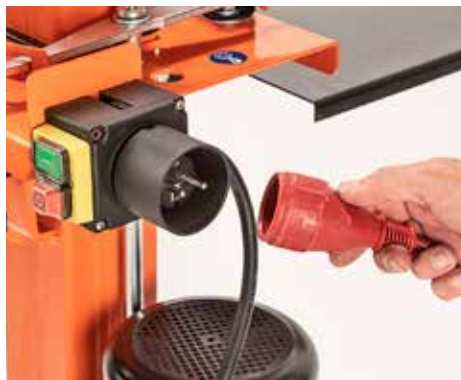
NETZ: An Stehendspaltern wird das Verlängerungskabel direkt angeschlossen.
