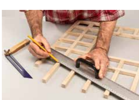
16 Zeichnen Sie nun die Giebelschrägen mit einer Schmiege und einem Stahllineal an ...
