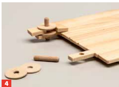
4 Leimen Sie die Rollen mit 6-mm-Dübeln auf die Rückseite der (geschliffenen) Torflügel; Distanzstücke legen den Abstand fest.
