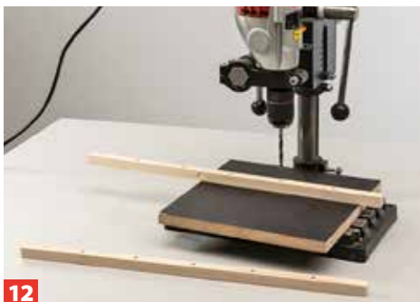
12 Am Abdruck der Zentrierspitzen bringen Sie nun senkrecht die Dübellöcher ein.
