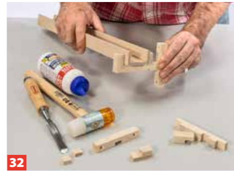
32 Die Rinne ruht später außen am Fachwerk auf solchen Rinnenträgern. Die exakte Montageposition ermitteln Sie zum Schluss.
