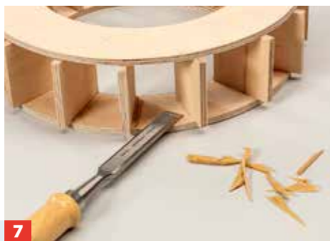
7 ... Holzklebstoff kleben Sie die Plättchen exakt vermittelt zwischen die Ringe. Nach dem Trocknen ausgetretenen Kleber entfernen.
