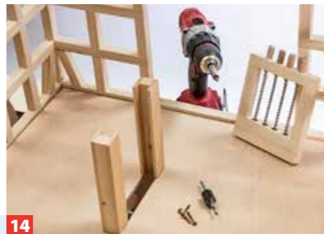
14 Jetzt verschrauben Sie von unten die beiden seitlichen Führungsschienen – exakt im Abstand des oberen Abschluss-Rahmenstücks.
