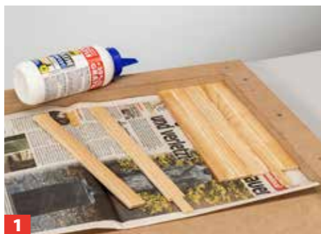
1 Der Bau der insgesamt drei Schiebetore ist relativ simpel: Verleimen Sie die erforderliche Anzahl an 5-x-20-mm-Leisten auf ...
