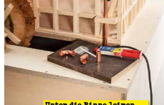
Fixieren Sie nun die Bauteile am Fachwerk und verkleben Sie das Kupferrohr mit den beiden 90°-Winkelstücken.
