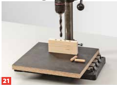
21 ... Löcher durch das obere Holz in das untere Holz hinein. Die Bohrtiefe ist auch abhängig von der Länge der Stichsägeblätter!
