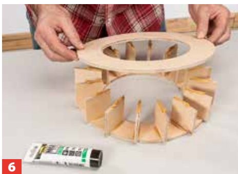
6 Etwas komplexer ist der Bau des Wasserrades. Schneiden Sie Ringe und Schaufelplättchen aus Sperrholz zu. Mit wasserfestem ...
