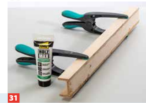
31 Das Wasser wird später durch einen Schlauchabschnitt in das Kupferrohr gepumpt und läuft durch diese Wasserrinne über das Rad.
