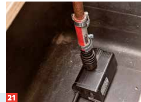
21 Die kleine Pumpe wird unter dem Kupferrohr mit Schlauch und Schlauchschellen montiert. Die Durchflussmenge ist regulierbar.
