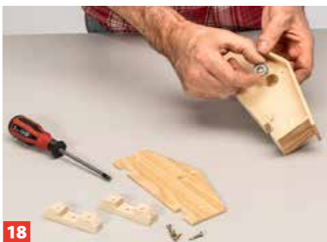
18 Das Lager wird in das durch die Beplankung entstandene Sackloch eingelegt und die gebohrte Dreiecksplatte vorne aufgeschraubt.
