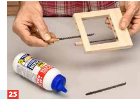
25 Nun leimen Sie die Dübel von oben in die Durchgangsbohrungen des Rahmens. Unten enden die Sägeblätter in den Sacklöchern.
