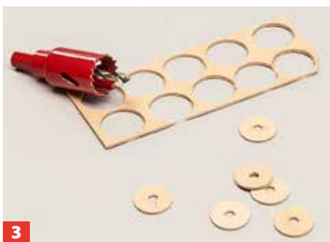
3 Mit einer Lochsäge schneiden Sie die Rollen – insgesamt vier Stück pro Torflügel – aus nur 2 mm starkem Sperrholz aus.
