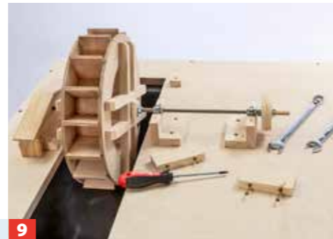
9 ... (M8) einsetzen, Antriebsscheibe und Wasserrad aufsetzen und alle Teile mit Muttern kontern. Dann das Außenlager montieren.
