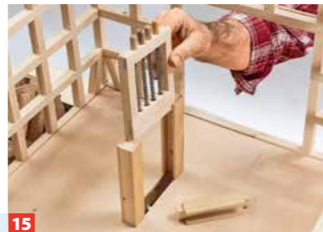
15 Stellen Sie das Gatter erneut ein. Beim Drehen des Wasserrads sollte nun der Dübel des Antriebsrads das Gatter heben und senken.
