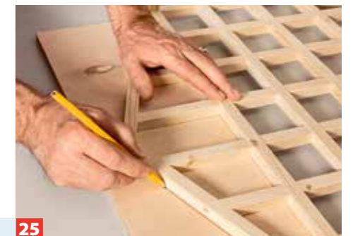
25 Nach dem Trocknen nehmen Sie das Dach vorsichtig ab. Auf Sperrholz reißen Sie danach zwei Giebel-Dreiecke auf.
