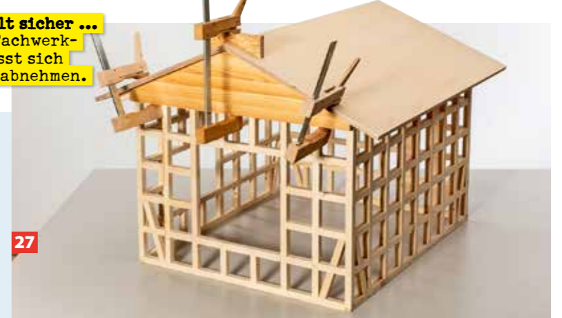
Die nun fertigen Giebelplatten werden zur Stabilisierung mit dem Dach verleimt, während es mittig auf dem Haus liegt.
