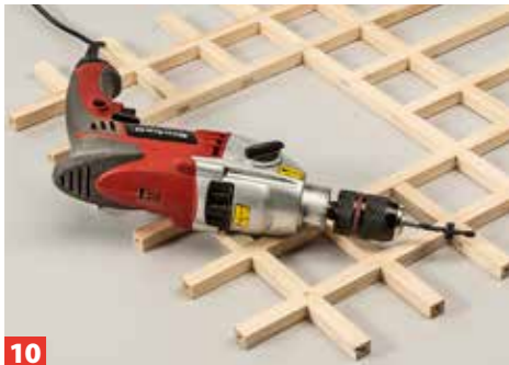
10 Bohren Sie nun mittig in die seitlichen Leistenköpfe 6-mm-Sacklöcher für die Verdübelung mit den Eckständern.
