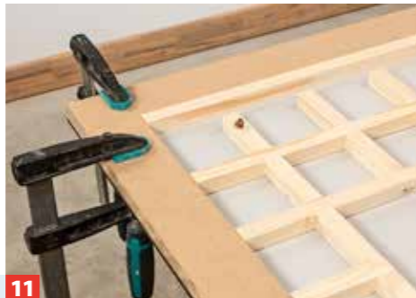
11 In der Winkellade übertragen Sie die Bohrungen mit Dübel-Markierspitzen auf die Ständer.
