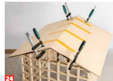
24 Anschließend haben wir die Dachplatten zugeschnitten, mit Klebeband fixiert und auf dem Haus (nicht mit dem Haus!) verleimt.
