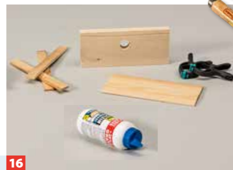
16 Der äußere Lagerbock ist etwas größer und „schöner“. Hier wird in die Holzplatte ebenfalls ein Loch für das Lager gebohrt. Auf ...
