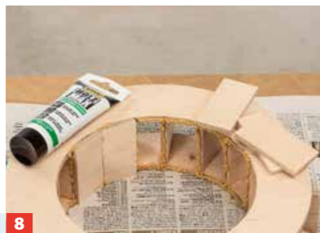
8 Danach werden von innen Sperrholzplättchen zwischen die Ringe geklebt. Der spaltüberbrückende Klebstoff dichtet alles ab.
