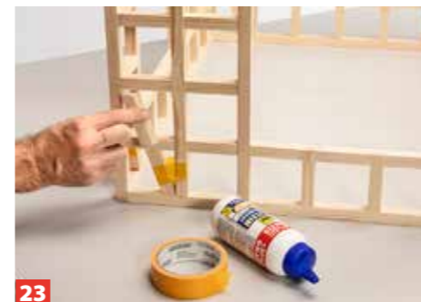
23 In den Ecken wurden noch jeweils schräge Bänder eingepasst und eingeleimt.
