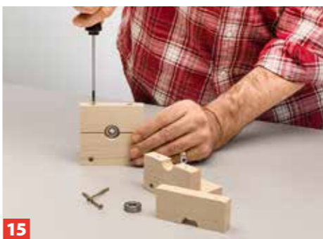
15 Nachdem die Halteplatten an einer Seite der unteren Lagerhalbschalen montiert wurden, werden die Lager festgeklemmt.
