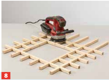
8 Nach dem Trocknen schleifen Sie die Flächen glatt und entfernen ausgetretenen Leim oder Klebstoff mit dem scharfen Stechbeitel.
