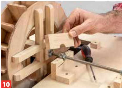
10 Prüfen Sie, ob sich das Wasserrad leicht drehen lässt. Dann die Lagerschalen aufschrauben. Tipp: Bei größerer Unwucht ggf. ein ...
