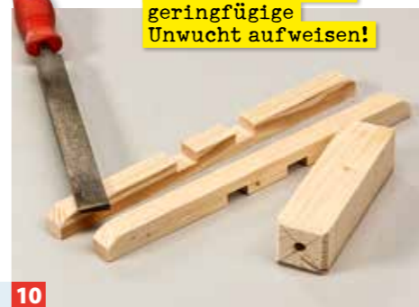
10 Jetzt stellen Sie die Vierkantnabe und die überblatteten Holzspeichen sorgfältig aus Holz her.
