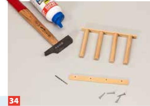
34 ... kleine genagelte Rollenstraßen für den Einschub und Auswurf an der Säge gebaut. Weitere Ideen können Sie selbst umsetzen!
