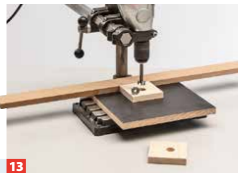
13 Nun geht es an den Bau der drei Lagerböcke. Die beiden innenliegenden Lager bestehen aus Leimholz, das für die Rillengerade ...
