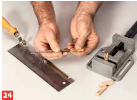
24 Als Sägeblattaufnahme verwenden Sie geschlitzte Runddübel. Stecken Sie die Sägeblätter in die Dübelschlitze.
