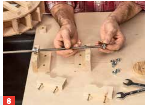
8 ... der Mitte des Feldes die Lage der Welle. Dort werden innen die Lagerböcke montiert. Kugellager und Edelstahl-Gewindestange ...
