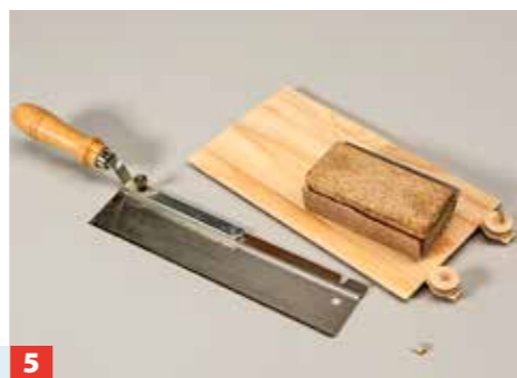
5 Die Dübel schneiden Sie nach dem Trocknen auf der Tor-Rückseite bündig ab. Kurz nachschleifen – fertig!
