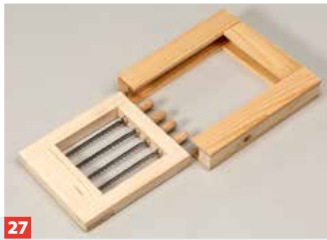
27 Leimen Sie die drei Einzelbauteile des Führungsrahmens noch nicht zusammen! Das erfolgt erst bei der Endmontage.
