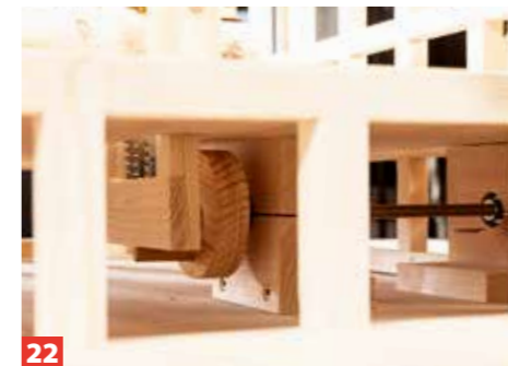
22 Der Blick in den Anlagenkeller zeigt die Funktionsweise: Die Dübelstange am Antriebsrad hebt den Sägegatter-Rahmen.
