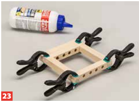
23 Leimen Sie den Innenrahmen der Säge rechtwinklig zusammen.
