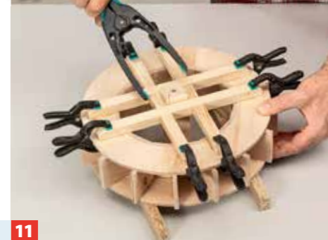
11 Die Speichen und die durchbohrte Nabe werden nun mit dem Holzrad verklebt.
