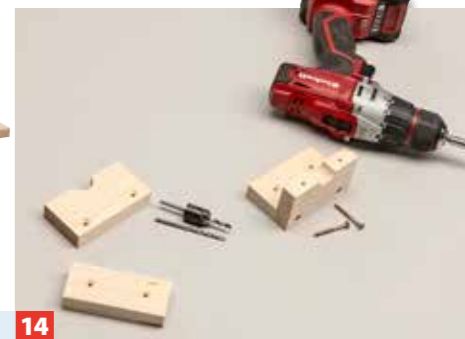
14 ... durchbohrt und dann längs aufgeschnitten wird. Für die Verschraubung des Halters und der Klemmschrauben bohren/senken.
