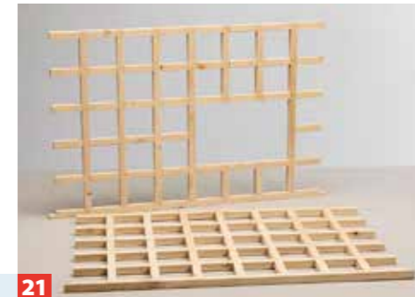
21 Und das sind die Traufwände mit oben und unten angedübelten Querbalken. Die unteren sind ausgeklinkt und stehen über!
