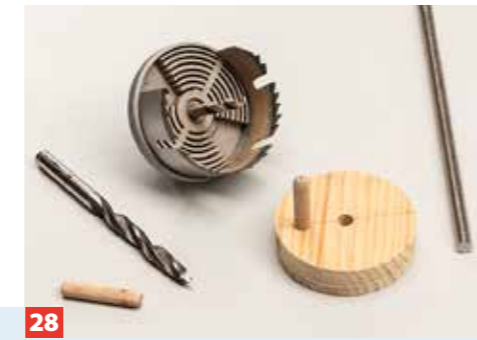
28 Für den Antrieb der Säge sorgt diese Scheibe mit Mittelbohrung für die Gewindestange und exzentrisch eingelassenem Dübel.
