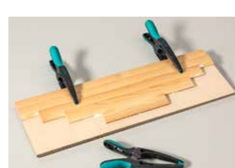
26 Leimen Sie nun auf die Rückseiten mit Überstand Flachleisten als Schupp-Schalung. Nach dem Trocknen schneiden Sie sie aus.
