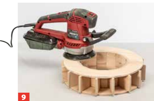
9 Nach dem Trocknen wird der überschüssige Klebstoff wieder mit einem Beitel abgestochen und die Flächen werden geschliffen.
