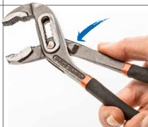
KLEMMSCHUTZ: Eine Nase (Pfeil) verhindert ein Zusammenklappen der Bügel (Volkers).
