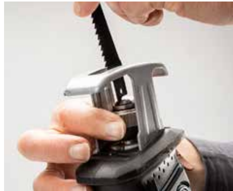
- SCHWER: Beim Profigerät von Bosch ist der Sägeblattwechsel knifflig
