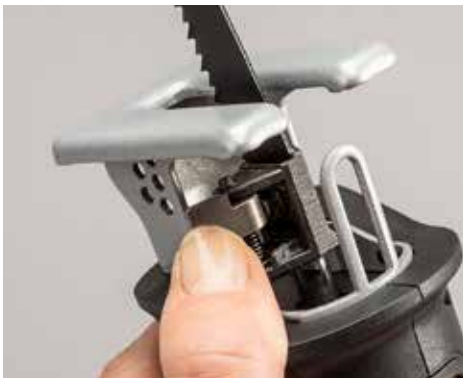
- STRAFF: Ein kleiner Hebel und hohe Federkraft erfordert bei Worx Fingerkraft.
