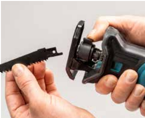
+ PRAKTISCH: Das Sägeblatt ist immer werkzeuglos montierbar (hier Makita).
