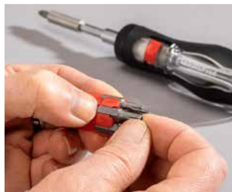
SCHWER: Bei Meister und Gedore sind die Bits kaum aus dem Halter zu bekommen.
