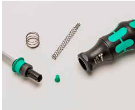
BRUCH: Der Wera -Griff hielt dem geforderten Drehmoment nicht stand.
