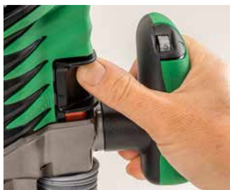
− UNSICHER: Bei Hikoki ist die Betätigung des nicht normgerechten Schalters mühsam.
