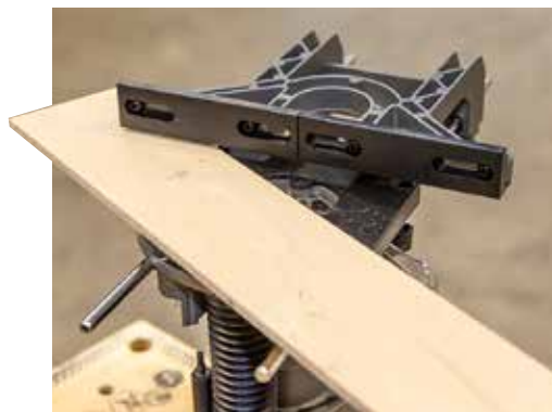
− SPALT: Dünne Werkstücke rutschen am Parallelanschlag vorbei ( Güde ).
