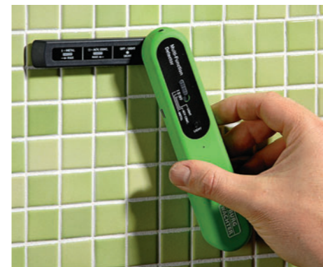
BLIND bleiben die preiswerten Detektoren – selbst an Leichtbauwänden
