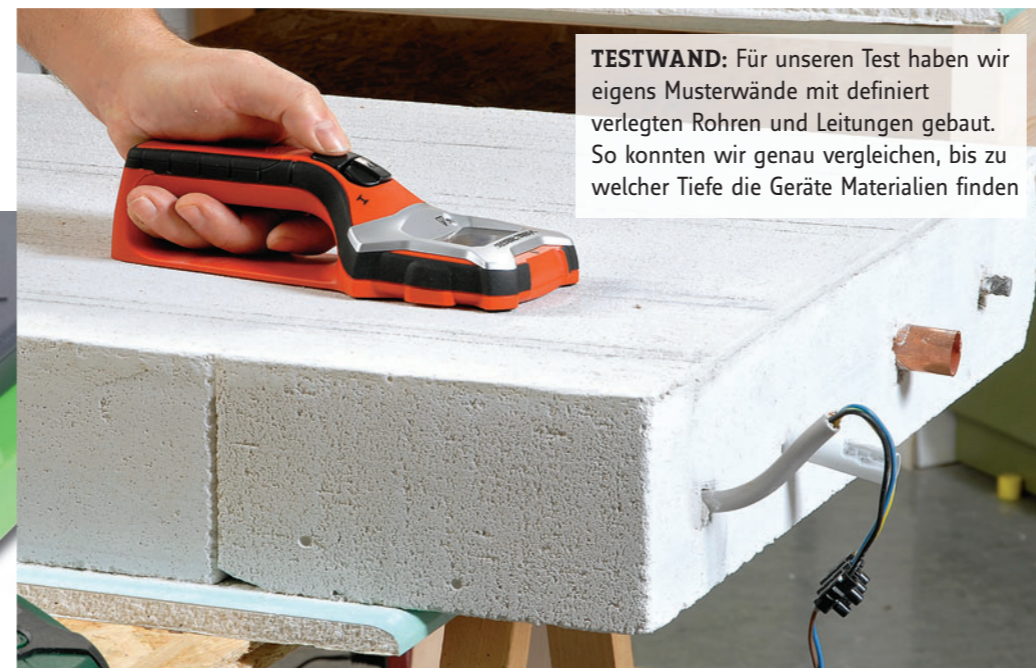
PRAXISNAH probiert Testleiter Michael Degen vom TÜV Rheinland die Ortungsgeräte auf einer für den Test präparierten Wand
