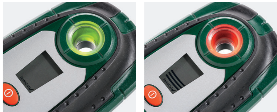
LEICHT VERSTÄNDLICH: Der Ring am PDO 6 von Bosch zeigt, ob das Gerät etwas in der Wand gefunden hat: Rot steht für Metalle, blinkendes Rot für eine Elektroleitung
