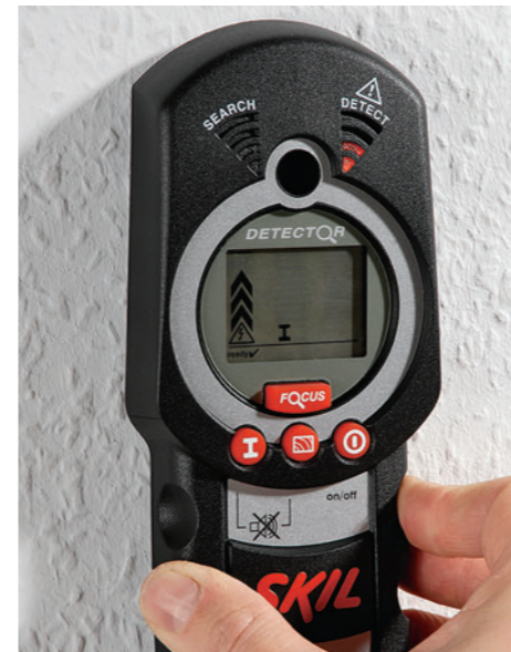
ALARM: Einige Geräte (hier Skil) zeigen Elektroleitungen – auch wo keine sind
