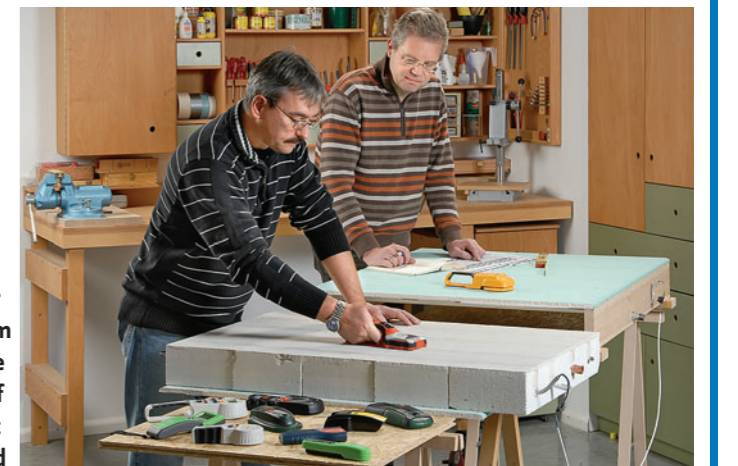
PRAXISNAH probiert Testleiter Michael Degen vom TÜV Rheinland die Ortungsgeräte auf einer für den Test präparierten Wand
