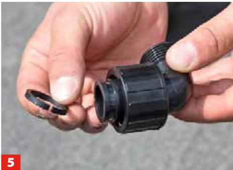
**5** Hier wird ein Sicherheitsring eingesetzt. Er sorgt dafür, dass die Rohrabschnitte fest miteinander verbunden sind.
