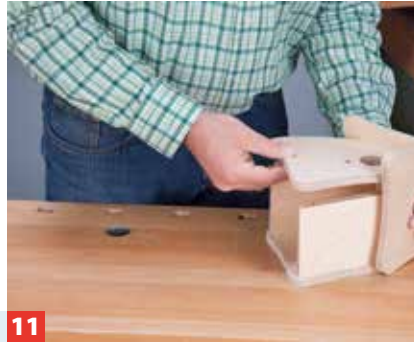
11 Nach dem Trocknen die Front ebenso positionieren. Nutzen Sie hierzu als Anschlag das fertig verklebte Dach.
