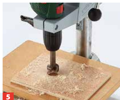
5 Mit Forstnerbohrer das Einflugloch bohren. Der Durchmesser sollte 30 mm sein, damit keine größeren Vögel nisten.
