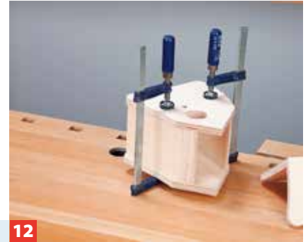
12 Wieder Klebstoff auftragen und bis zum Abbinden mit Leimzwingen anpressen.
