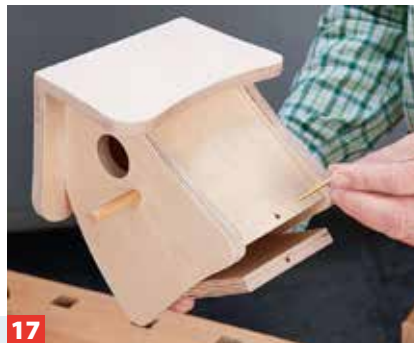
17 Diesen stecken Sie durch die Seite in den zugeklappten (hier nur zum besseren Verständnis geöffneten) Boden.
