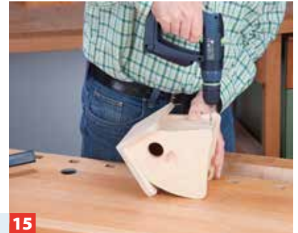
15 Bohren Sie nun auf halber Materialstärke durch die den Scharnieren gegenüberliegende Seitenwand in den Boden.
