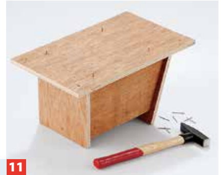
11 Nun können Sie die Rückwand mit dem Spatzenhaus verkleben und nageln.
