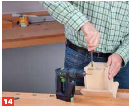
14 Schneiden Sie den Boden zu und schrauben ihn mit kleinen Scharnieren an einer Seitenwand fest. Vorbohren!
