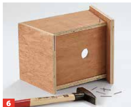
6 Jetzt die Frontplatte mit dem Einflugloch klappbar auf zwei seitlich eingeschlagenen Stiftnägeln lagern.
