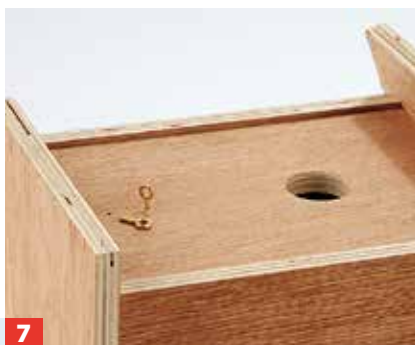
7 Drehen Sie die beiden Ösenschrauben im Abstand von 20 mm, ausgehend von der unteren Kante, in die Frontplatte.
