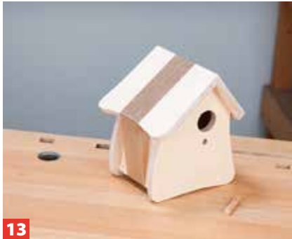
13 Danach das Dach aufsetzen. Eventuelle Spalte am Dachanschluss füllt der leicht schäumende Klebstoff aus.
