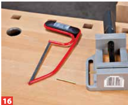
16 Längen Sie ein Stück Messing-Rundstab als Sicherungsbolzen für den Boden ab.
