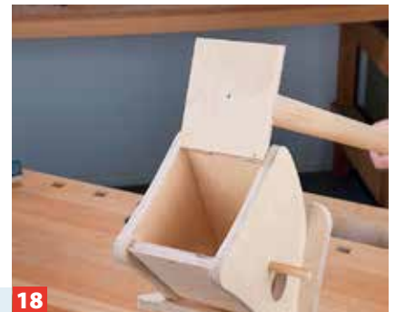
18 Unter die Bodenplatte schrauben Sie von innen einen Rundstab als Vogelhauseinsteller fest. Vorbohren!
