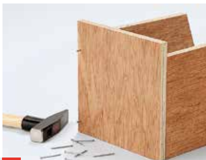
2 Tragen Sie nun den Konstruktionsklebstoff auf. Die Verbindungen mit Drahtstiften zusätzlich fixieren.
