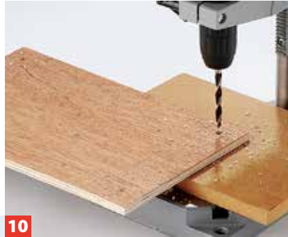
10 In die Ecken der Rückwand bohren Sie je ein Loch für die Befestigung am Baum.
