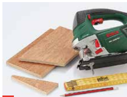
1 Zuerst die beiden Seitenwände sowie den Boden ausmessen und die Platten mit der Stichsäge zuschneiden.
