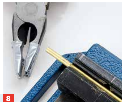
8 Den Messingdraht im 90-Grad-Winkel abkanten. Zange zuvor abkleben, um Druckstellen zu vermeiden.
