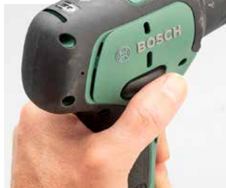
LEICHT: Bei Bosch wird die Drehrichtung per Tippschalter geändert.
