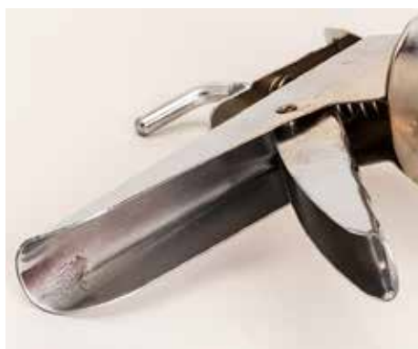
- SCHARFKANTIG: Bei Go On kann man sich leicht am Blech verletzen.
