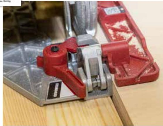
**+ FÜHRUNG:** Die Worx-Maschine kann an einem Brett geführt werden – dafür ist der beigelegte Parallelanschlag nutzlos. Die Führung liegt allerdings auf der Restholz-Seite.
