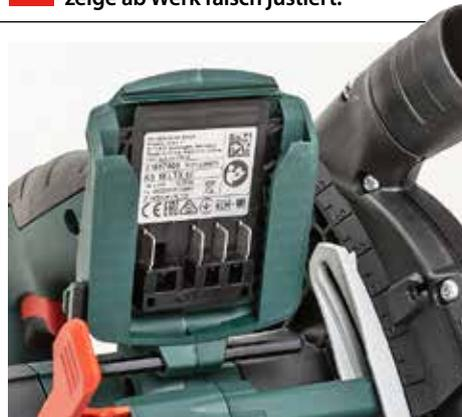
**UNSICHTBAR:** Bei Metabo verschwindet der Sicherheitshinweis unter dem Akku.
