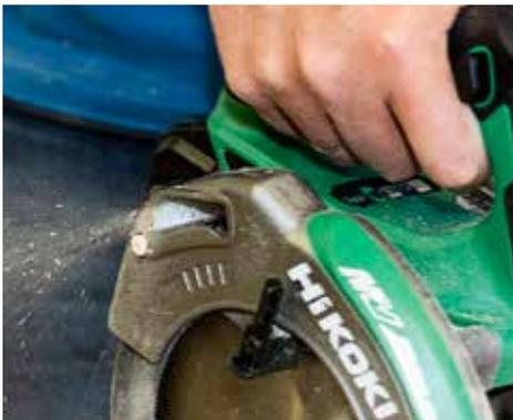
**UNGESUND:** Bei Hikoki wird kein Adapter für den Staubsauger mitgeliefert.
