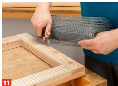
**11** Der überschüssige Kaninchendraht wird mit einem Seitenschneider abgeschnitten.
