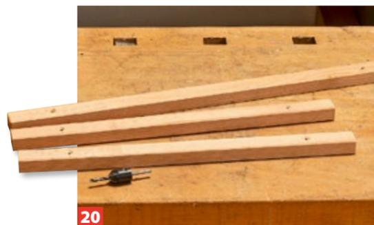
**20** Die Anschlagleisten werden auf Länge geschnitten, vorgebohrt und angesenkt.
