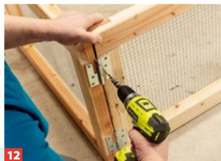
**12** Nun montieren Sie Aushebescharniere von außen an allen vier Ecken des Geheges.
