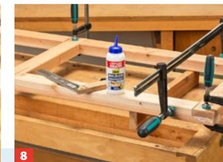
**8** Während der Trocknungszeit des Leims wird der Rahmen mit Zwingen verspannt.
