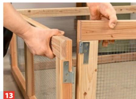
**13** Die Aushebescharniere wurden befestigt, um das Gehege bei Bedarf ganz leicht demontieren zu können.
