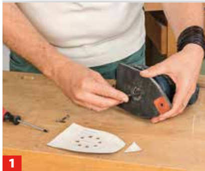
1 Zunächst montierte Werkzeuge und Werkzeugaufnahmen abmontieren – hier die Schleifplatte des Geräts.
