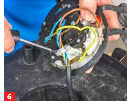
3 Wir haben zunächst die Thermosicherung getauscht: Anschlüsse lösen, Verbindungsleitungen abnehmen.
