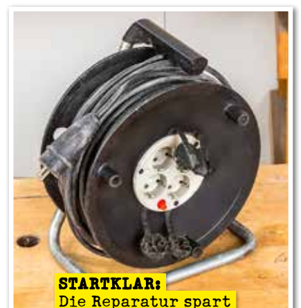
8 Vor der erneuten Montage haben wir die Steckdosen der Verteilung auf Funktion geprüft.
