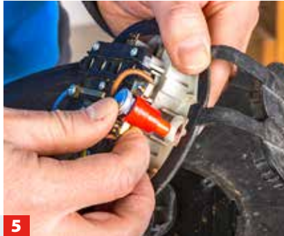
2 Nun können Sie die komplette Anschlussplatte vom Trommelkörper abziehen. Leitung etwas zurückziehen.
