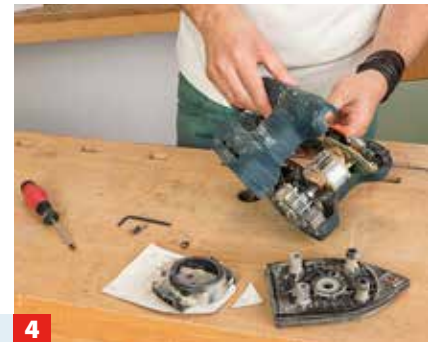
4 Alle Gehäuseschrauben entfernen – das erfordert manchmal spezielle Antriebsprofile wie zum Beispiel Torx mit Mittenbohrung.
