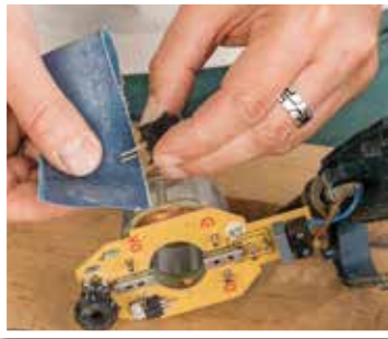
1 Zunächst montierte Werkzeuge und Werkzeugaufnahmen abmontieren – hier die Schleifplatte des Geräts.
