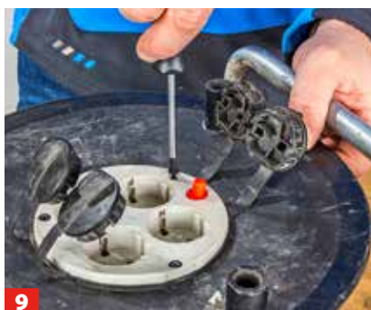
7 ... Leitung wieder in Position schieben und sichern. Achten Sie auf den spannungsfreien Verlauf der Leitungen.
