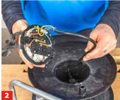
2 Nun können Sie die komplette Anschlussplatte vom Trommelkörper abziehen. Leitung etwas zurückziehen.
