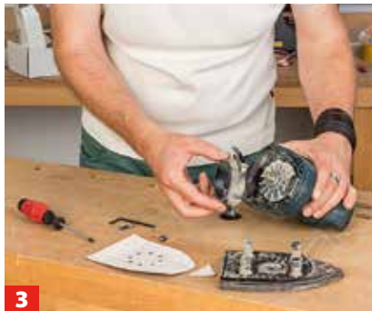
3 Alle die beiden Schalen verbindenden Elemente entfernen – oft sind Schalterkulissen oder Anzeigeelemente nur gesteckt.
