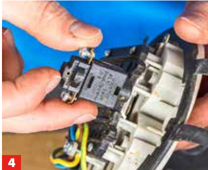
1 Lösen Sie zunächst die Verschraubungen in den Steckbuchsen oder – wie hier – daneben auf der Anschlussplatte.
