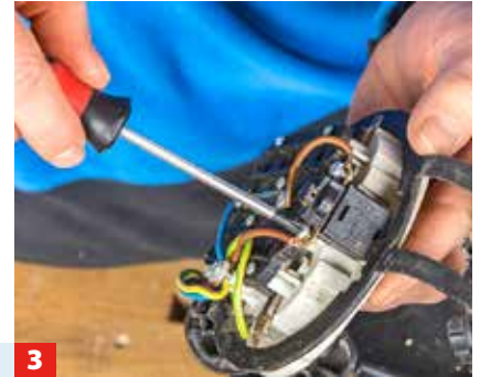
3 Wir haben zunächst die Thermosicherung getauscht: Anschlüsse lösen, Verbindungsleitungen abnehmen.
