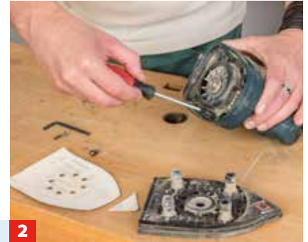
2 Das Gehäuse besteht meist aus zwei Halbschalen. Zuerst verbindende Bauteile demontieren.
