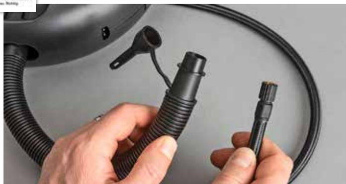
**DOPPEL:** Der linke Schlauch wird mit Ventilator versorgt, der rechte Druckschlauch aus dem Kompressor (hier bei Oasser).
