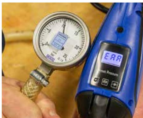
**-** **STÖRUNG:** Im Druck-Maximalbereich zeigt die AGT-Pistole eine Störungsmeldung.
