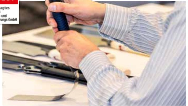
**+** **STABIL:** Alle getesteten Sägen bestanden den Belastungstest der VPA, bei dem die Sägeblätter um 90° verformt wurden.
