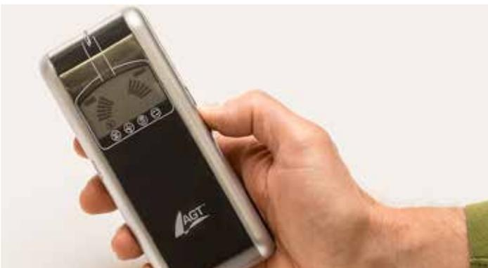
**+ DEUTLICH:** Oft wird die Intensität eines Ergebnisses auf dem Display als Tachoanzeige mit Balken anschaulich gemacht.
