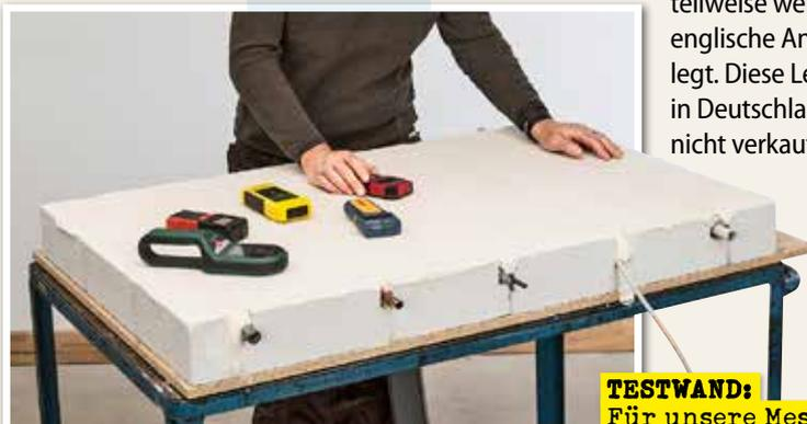
**TESTWAND:** Für unsere Messungen wurden Rohre und Leitungen in definierten Tiefen in einer Wand „versteckt“.
