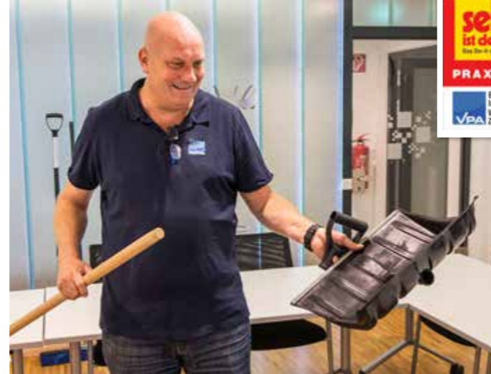
BAUSATZ: Der Schieber aus dem Platin Shop zerlegte sich im Test in seine Einzelteile. Eine Verschraubung ist nicht vorgesehen.
