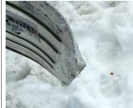
VERBOGEN: Das Schild bei Dema hakelte stark – und verbog sich schließlich.
