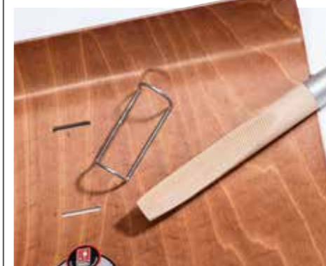
GELÖST: Die Klammerverbindung bei Ideal erwies sich im Test als nicht stabil.
