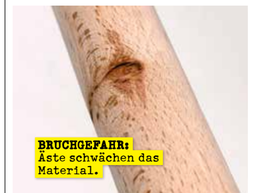
BRUCHGEFAHR: Äste schwächen das Material.
