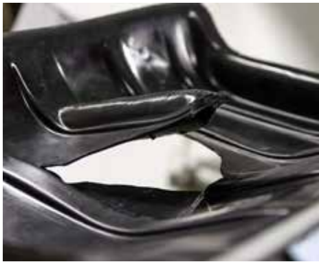
RISS: Der Schneeschieber des Platin Shop überstand die Belastungsprüfung nicht.
