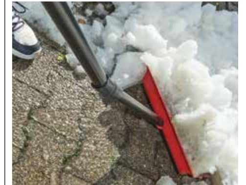
ABGELÖST: Das Jago -Teleskop löste sich im Test bei Belastung.
