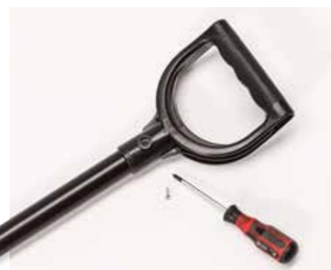
PASST NICHT: Die Bohrung erlaubte bei Jago die vorgesehene Fixierung nicht.
