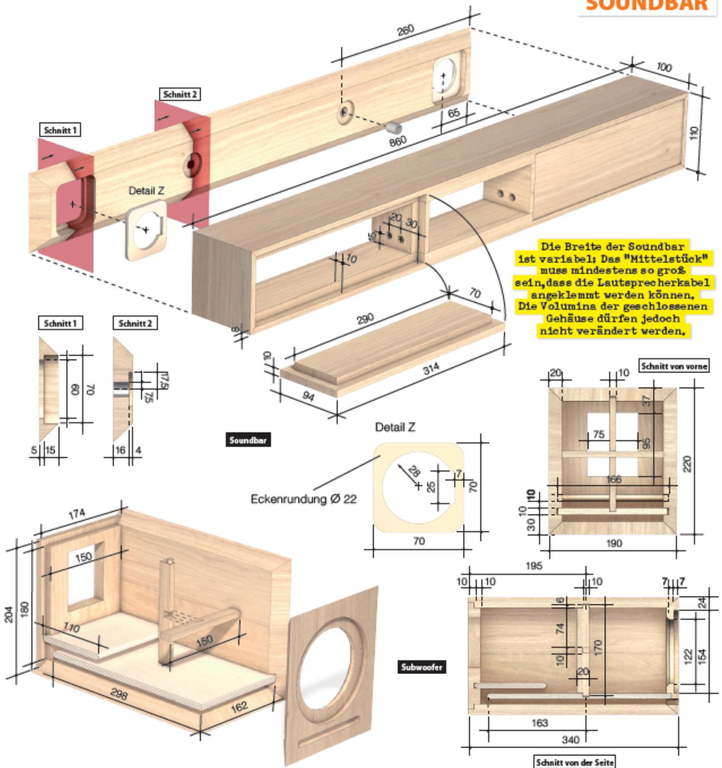
Die Breite der Soundbar ist variabel; Das "Mittelstück" muss mindestens so groß sein, dass die Lautsprecherkabel angeklemt werden können. Die Volumina der geschlossenen Gehäuse dürfen jedoch nicht verändert werden.
