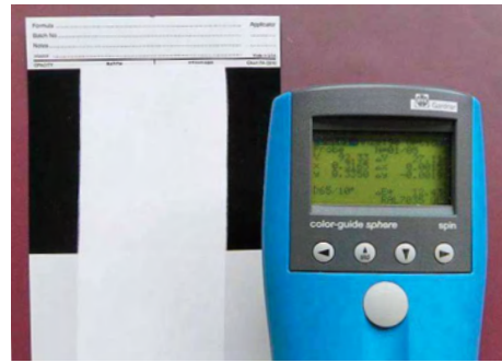
KONTRASTMESSUNG: Weißgrad sowie Kontrastverhältnis zwischen schwarzem und weißem Untergrund werden gemessen.
