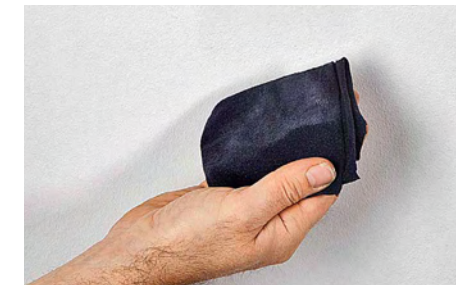
Nur gut, dass dies kein Smoking ist: Weißer Kalkabrieb fällt hier besonders auf. Problematisch ist das auch für Folgeanstriche.
