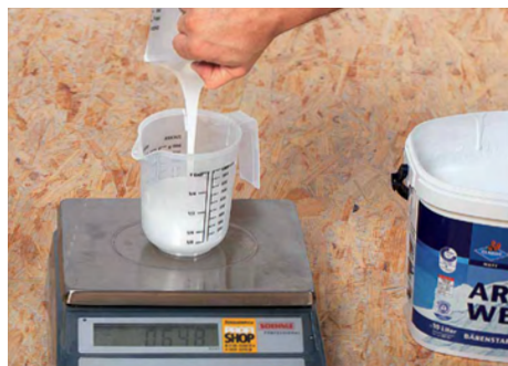
AUSLITERN: Zur Berechnung der Reichweite mussten wir bei allen Farben das Gewicht von einem Liter Farbe ermitteln.
