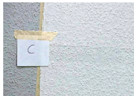
PRAKTISCHE DECKKRAFT: Anders als beim Labortest wurde hier die Deckkraft beim praktischen Auftrag begutachtet.
