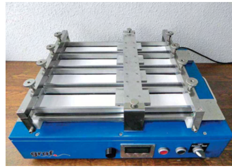
NASSABRIEB: Nach 28 Trocknungstagen werden die Proben Scheuerzyklen unterworfen, danach die Materialabnahme gemessen.
