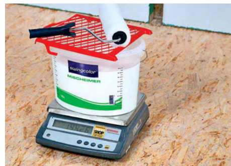
ANONYM: Die Farben wurden umgefüllt, um Vorurteilen vorzubeugen. Eimer, Farbe, Rolle und Abstreifgitter wurden gewogen.
