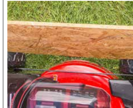
ABSTAND: Bei Einhell wird durch die Spurbreite etwas Randnähe „verschenkt“.
