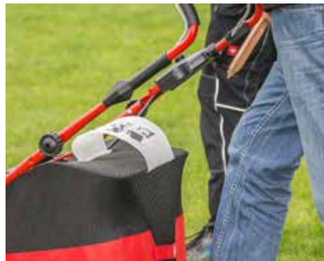
DEUTLICH: Bei Einhell zeigt ein Flatterband, wann der Fangkorb voll ist.
