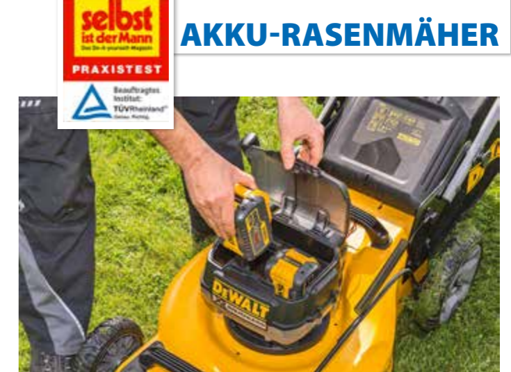
KOMPATIBEL: Wie hier bei DeWalt können Sie die Betriebsakkus teilweise auch für andere Garten- und Elektrowerkzeuge nutzen.
