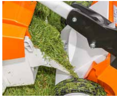
PRAKTISCH: Bei Stihl vermeidet eine Korblasche das Herausquellen von Gras.
