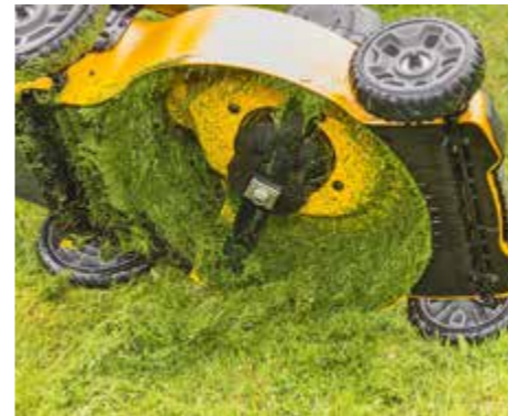
ZUGESETZT: Bei DeWalt fehlte die Kraft, das Schnittgut in den Korb zu fördern.
