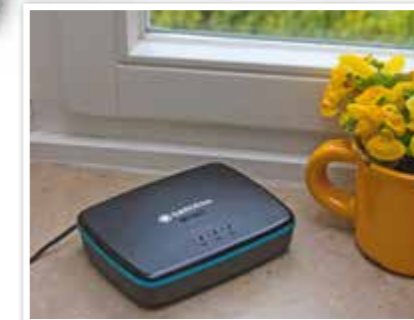
Die Gardena Systemzentrale (Gateway) baut über den Router eine Verbindung zum Internet auf. Die kompatiblen ...
