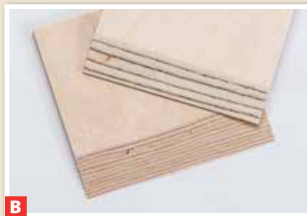
Stabiler als normales Sperrholz (oben) ist viellagiges Fliegersperrholz (unten).
