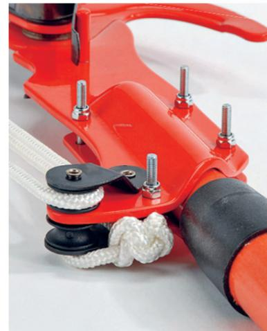
**VERLETZUNGSGEFAHR:** Die Schrauben zur Befestigung am Teleskopstiel stehen bei dieser Schere weit über.
