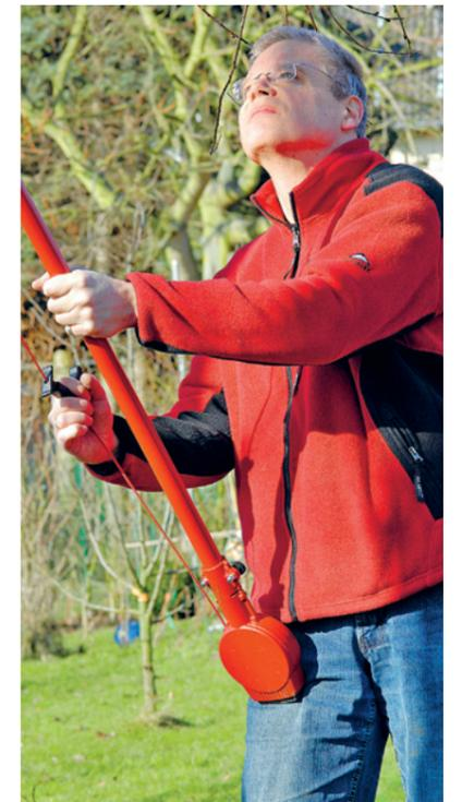
**SEILFIX:** Der als Zubehör erhältliche Seilroller nimmt das sonst unkontrolliert herumschwingende Zugseil auf.
