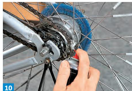
**10** ... verwendet werden. Kette mit speziellem Kettenöl schmieren. Eine Erstschmierung ist auch aus der Tube möglich.
