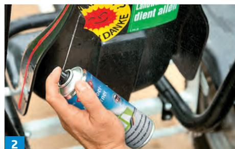
2 Aufkleberentferner (hier *Speziallöser* von *Caramba*) an den Rändern aufsprühen. Einige Minuten einwirken lassen.
