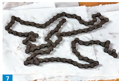
**7** Gereinigte Kette dann am besten auf einigen Lagen Zellstoff zum Trocknen auslegen. Das dauert nicht lang.
