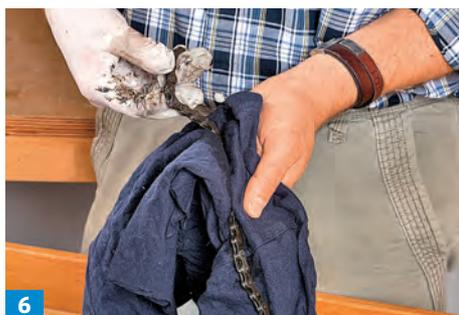
**6** Kette nach der Reinigung durch einen alten Baumwoll-Lappen ziehen, um den Kaltreiniger zu entfernen.
