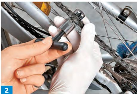
**2** ... bereits eingeschränkt. Zunächst das Kettenschloss öffnen oder – hier gezeigt – einen Niet mit einem Kettenwerkzeug ...
