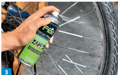
3 Auch die Felgen können mit Sprühöl gereinigt werden. Nach kurzer Einwirkzeit Schmutz mit einem Tuch abnehmen ...
