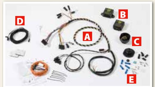
**ELEKTROSATZ:** Der Kabelbaum **A** wird über eine Schalt- und Überwachungselektronik **B** mit der Steckdose **C** verbunden. Stecker, Verbinder **E** und Zusatzleitungen **D** stellen den Kontakt zur Fahrzeugelektrik her.
