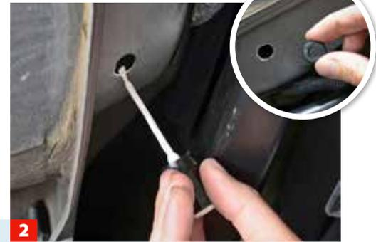
**2** Blechkanten entgraten und gegen Rostbefall mit etwas Lack behandeln. Danach wird eine Schutztülle angebracht.
