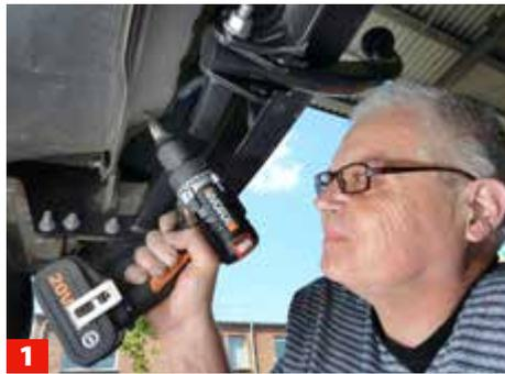
**1** Zunächst wird eine Bohrung für die Verlegung der Anschlussleitung aus dem Fahrzeug zur Steckdose am Zugkopf hergestellt.
