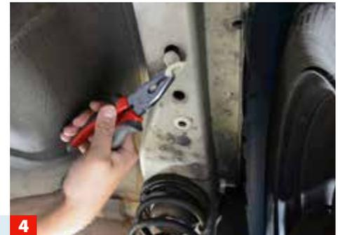
An der Unterseite des Fahrzeugs liegende Öffnungen sind meist mit Stopfen verschlossen, um Feuchtigkeit abzuhalten.
