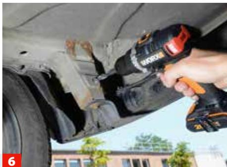
... komplett demontiert werden. Manchmal müssen auch Befestigungslöcher gebohrt werden – Bohrlöcher dann entgraten!
