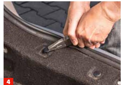
**4** ... verschraubt, außerdem halten Clips die Formteile in Position. Clips vorsichtig mit einer Zange abheben, um diese wieder ...
