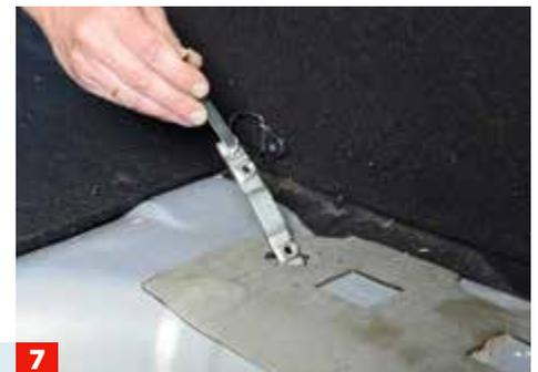
Pfiffig: Hier sind Montagemuttern auf einem Träger montiert, der eine gezielte Positionierung in einem Hohlraum erleichtert.
