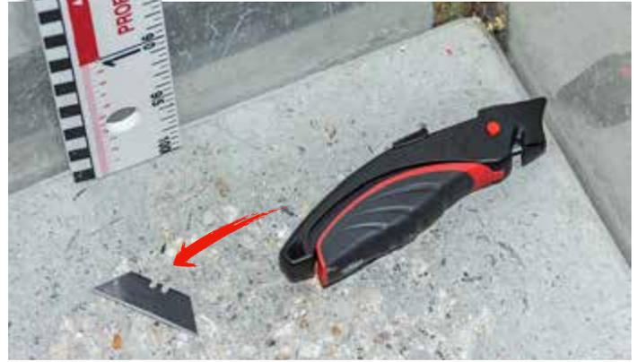
**- AUSFALL:** Beim Falltest verlor das KDS-Messer die Schneidklinge, außerdem öffnet sich das Magazin – das kann gefährlich werden.
