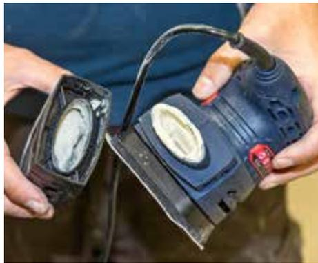
**- PASST NICHT:** Bei Güde kann kein Staubsauger angeschlossen werden.
