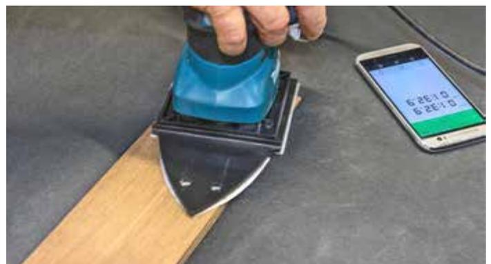
**+ EFFEKTIV:** Der Abtransport mit angeschlossenem Staubsauger funktionierte stets gut – hier beurteilt auf schwarzer Pappe.
