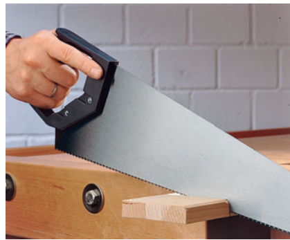
Zuerst steil, dann flacher sägen und in möglichst langen Zügen arbeiten
