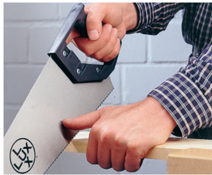
Sägeblatt im hinteren Bereich auf die Werkstückkante aufsetzen, anritzen
