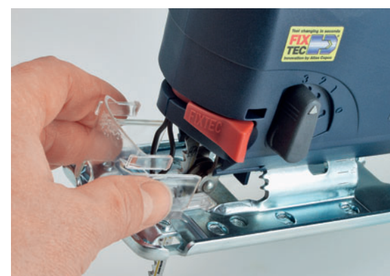
Schutzkappen verbessern eventuell die Funktion der Absaugung, verringern aber die Sicht
