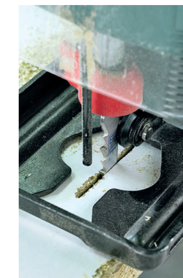
Vor allem beschichtete Werkstoffe reißen leicht aus
