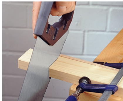
Ist das Restholz zu klein, Zulage hinter das Werkstück spannen
