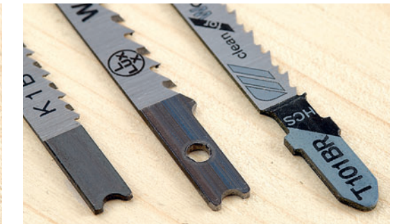
Stichsägeblätter werden mit verschiedenen Schafformen gerätespezifisch angeboten A Stahl wird mit HSS-Blatt und feinsten Zahnung getrennt. B Weichere Metalle können mit feiner Zahnung gesägt werden. C Mittlere Zahnungen sind vielseitig für Holz einsetzbar, D hinterschliffene Blätter eignen sich für feine Arbeiten in Holz und Kunststoff. Geschweifte Spitzen E erleichtern Tauchschnitte mit Stichsägen
