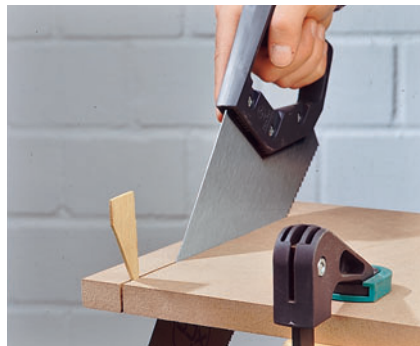
Gegen Klemmen wird der Säge-schnitt mit einem Keil stabilisiert
