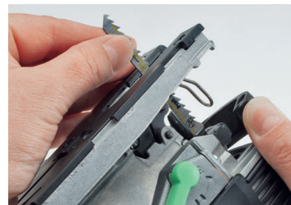
Der Sägeblattwechsel funktioniert bei fast allen aktuellen Modellen werkzeuglos
