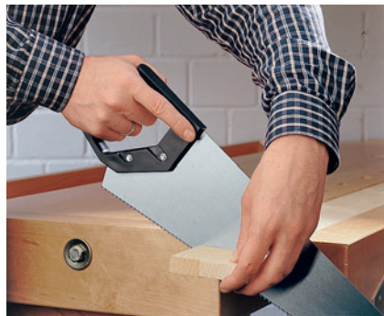
Am Ende des Sägevorgangs Restholz gegen Abreißen in Position halten
