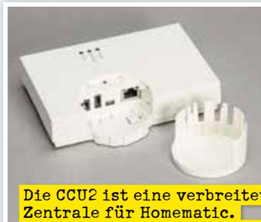
Die CCU2 ist eine verbreitete Zentrale für Homematic. Sie beinhaltet die Logik für die Gerätesteuerung und einen Internet-Zugang.
