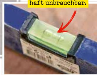
**GEBROCHEN:** Nicht reparabel brach diese Libelle aus dem Körper der *BMI Eurostar*-Wasserwaage.
