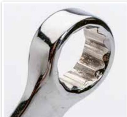
**FEHLERHAFT:** Im Inneren des Ringprofils ist die Verchromung unzureichend.
