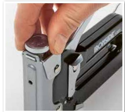
**SPANNUNG:** Die Schlagkraft ist bei Billig-Tackern oft stufenlos regulierbar.
