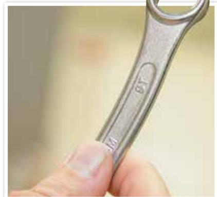
**KRUMM:** Dieser Schlüssel verbog sich bei Nennlast dauerhaft.
