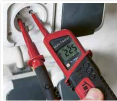
**DUSPOL:** Das einfach zu bedienende Gerät vermeidet Messfehler bei der Prüfung von Stromkreisen.
