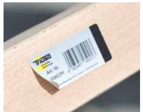
- FLÜCHTIG: Die Kennzeichnung beim Triuso -Bock ist zu leicht abziehbar.
