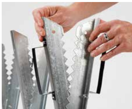
VERBOGEN: Der Deuba -Sägebock klemmt beim Zusammenklappen.
