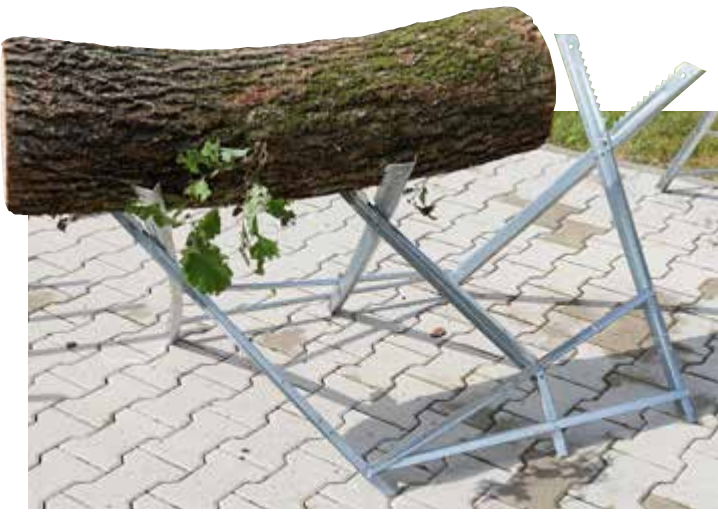
GEKNICKT: Der Sägebock von baumarktplus.de gab unter diesem Eichenstamm nach – das kann gefährlich werden!
