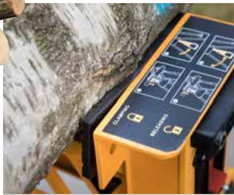
- KNAPP: Für dickere Stämme ist der Klemmbereich bei Batavia zu flach.
