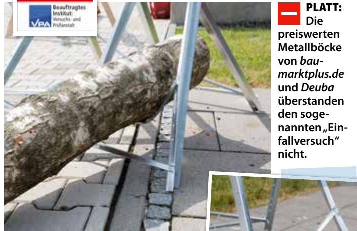
ZU INSTABIL: Die dünnen Gestänge können den in der Prüfanforderung geforderten Tests nicht widerstehen.
