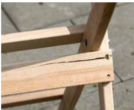
- BRUCH: Der Dema -Bock war nach dem Belastungstest der VPA Brennholz.
