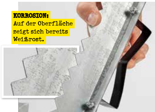
MÄNGEL: Korrosion und dünnes Material beim Sägebock von Deuba .
