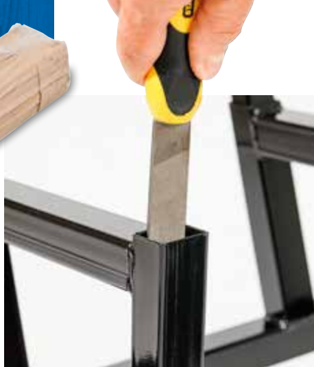
NACHARBEIT: Beim Modell von D&S Vertrieb störte eine Schweißstelle die Montage.
