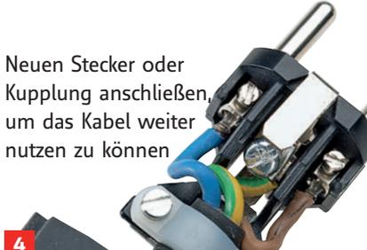
4 Neuen Stecker oder Kupplung anschließen, um das Kabel weiter nutzen zu können
