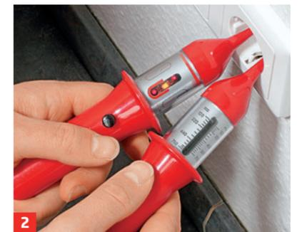
2 Werden beide Pole belegt, kann getestet werden, ob Strom fließt
