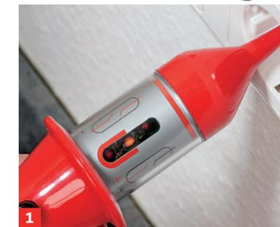
1 Mit einem Duspole kann die Phase schnell ausfindig gemacht werden
