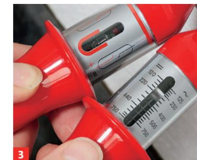
3 Die Höhe der Spannung wird bei diesem Modell auf Knopfdruck angezeigt
