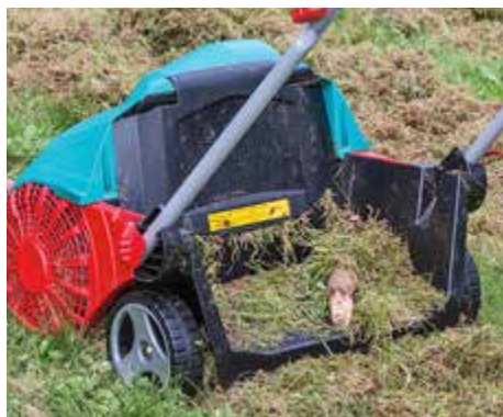
+ GESTOPPT: Die Federklappe bremst Fremdkörper (hier bei Bosch).
