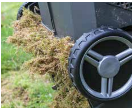
- VERSTOPFT: Bei Stiga setzt sich Moos zwischen Gerät und Fangkorb.
