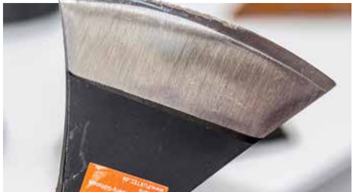
ROSTET: Im geschärften Klingebereich beginnt das Beil von Fuxtec schon vor der ersten Nutzung zu rosten.
