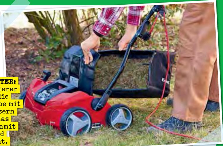
**MOOSVERNICHTER:** Der Vertikutierer durchkämmt die obere Grasnabe mit scharfen Messern und lockert das Wurzelwerk damit auf. Moos wird dabei entfernt.
