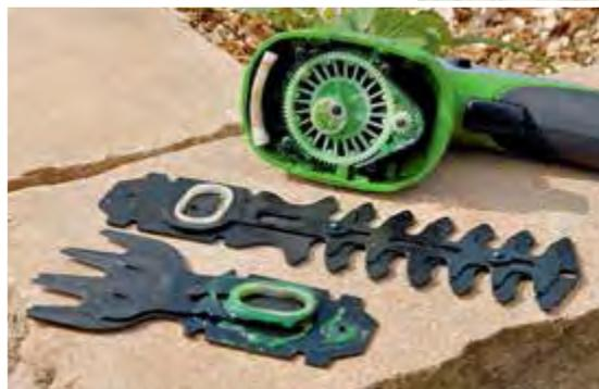
**WECHSEL:** Viele Geräte sind mit Wechselköpfen auch für den Buchsbaum-Schnitt nutzbar. Der Wechsel ist einfach – aber manchmal wie hier fettig.
