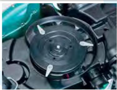
Viele Roboter mähers – hier der Indego von Bosch – mähen mit wechselbaren Klingen auf einer Messerscheibe.
