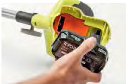
Die Maschine arbeitet mit den 18-Volt-Systemakkus des Herstellers.
