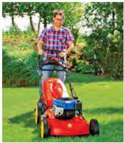
**BENZIN:** Kraftvoller Antrieb auch bei großen Schnittbreiten. Ein Radantrieb erleichtert das Führen der relativ schweren Geräte. Vergleichsweise hoher Wartungsaufwand des Motors.
