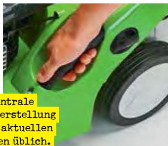
Eine zentrale Höhenverstellung ist bei aktuellen Modellen üblich.
