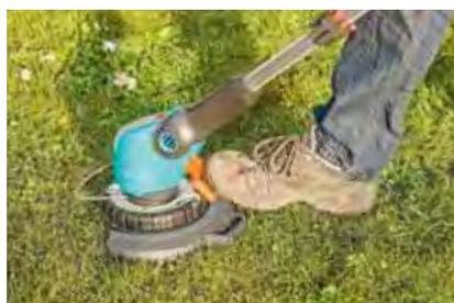
... mit dem Fußpedal wird der Trimmerkopf abgewinkelt und mit ...
