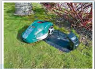
Der Roboter lädt seinen Akku bei Bedarf an der am Rand montierten Ladestation, auch dieser Vorgang geschieht automatisch.
