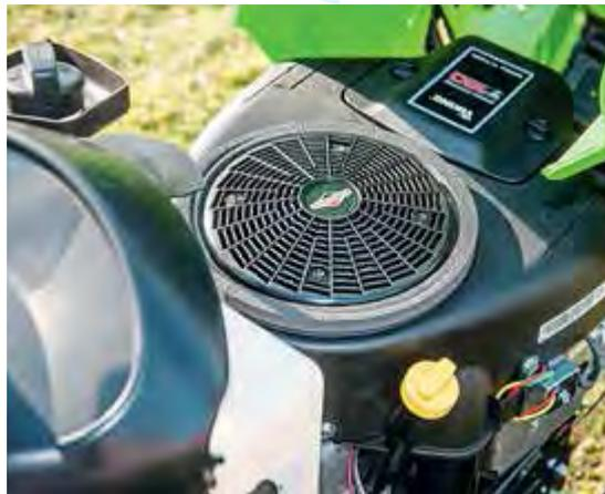
**KRAFTVOLL** arbeitet der 11,5-Kilowatt-Motor von Briggs & Stratton mit zwei Zylindern.
