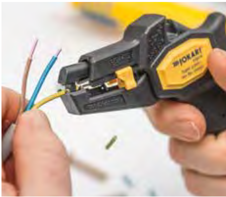
+ PRÄZISE: Die Werkzeuge von Jokari und Weicon trennen die Hülle sauber.
