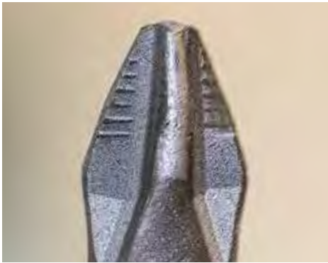
- VERFORMT: Dieses KWB-Bit* verformte sich im Drehmoment-Test sichtbar.
