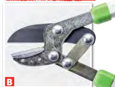
**VERSTÄRKER:** Die Betätigungskräfte können per Getriebe **A** oder Hebelmechanik **B** unterstützt werden.
