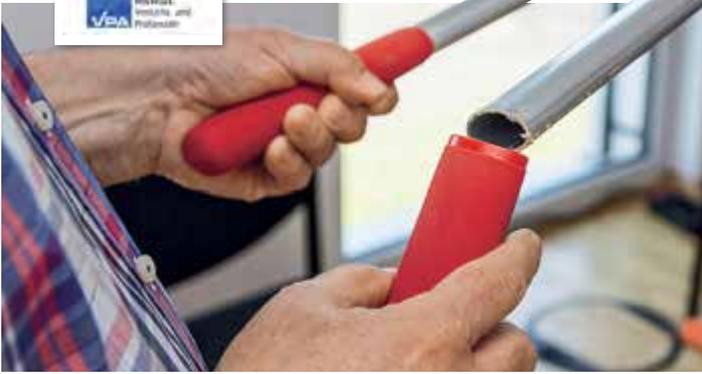
**- UNSICHER:** Ausgerechnet bei den Modellen des Profiherstellers *Felco* ließen sich die Griffe zu leicht abziehen.
