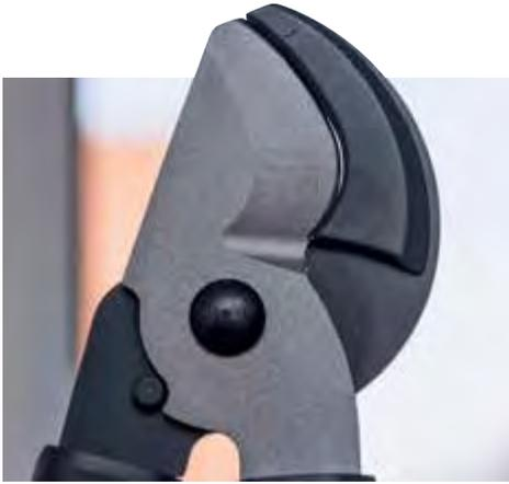
**UNPRÄZISE:** Bei einigen Bypass-Scheren (hier Gardena) schließt die Klinge nicht.
