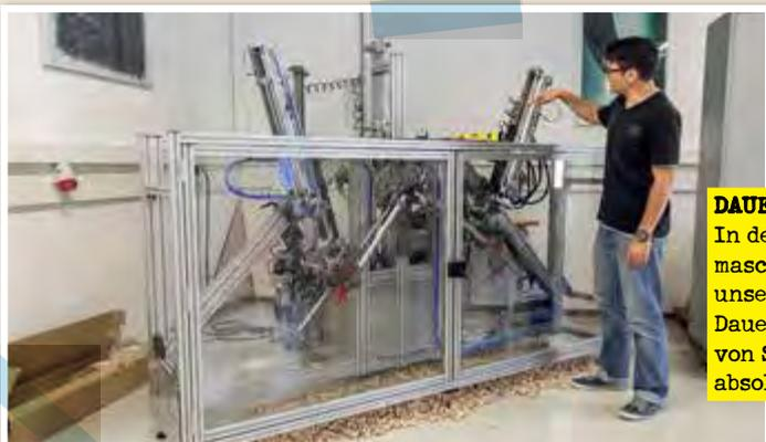
**DAUERTEST:** In der neuen Prüfmaschine mussten unsere Testscheren im Dauerlauf hunderte von Schnitten absolvieren.
