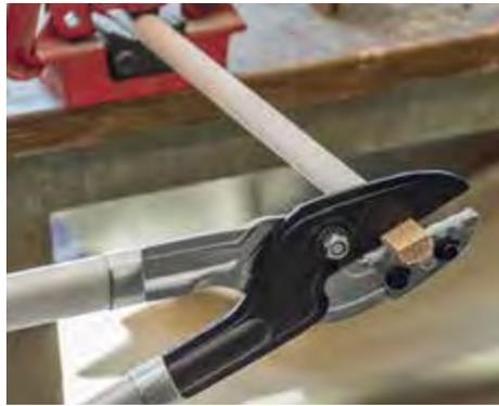
**ABGEGLITTEN:** Hier (bei Berger) gleitet das Schnittgut im Scherenmaul.
