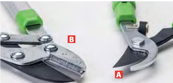
**DER KLEINE UNTERSCHIED:** Bei *Bypass*-Scheren gleitet die Schneide am Widerlager vorbei **A**, ihnen sagt man die präziseren Schnitte nach. Bei *Amboss*-Scheren **B** drückt die Klinge auf das Widerlager.
