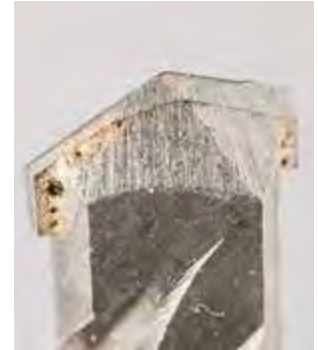
LÖTFEHLER: Bei Work Plus sind deutliche Löcher im Lot erkennbar.
