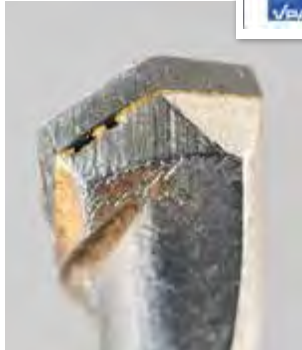
FEHLSTELLEN: Hier wurde am Lot gesparrt ( Westfalia ).
