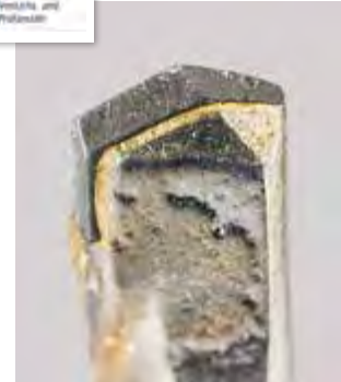
SCHMIEDEFEHLER: Unsaubere Oberflächen am Westfalia -Bohrer Größe 5.
