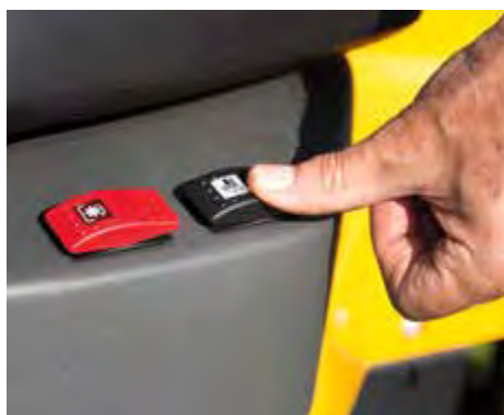
+ BEQUEM: Beim Frontmäher von Stiga wird das Mähwerk elektrisch bedient.
