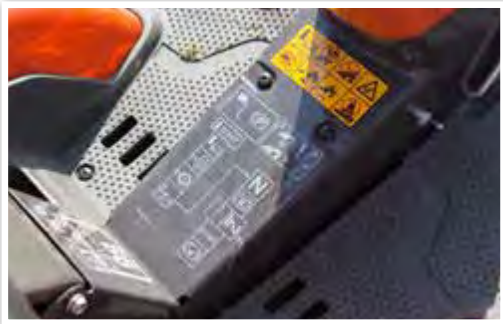
+ PIKTOGRAMME: Bei Husqvarna sind sie gut sichtbar am Lenktunnel angebracht – die Anleitung enthält detaillierte Erläuterungen.
