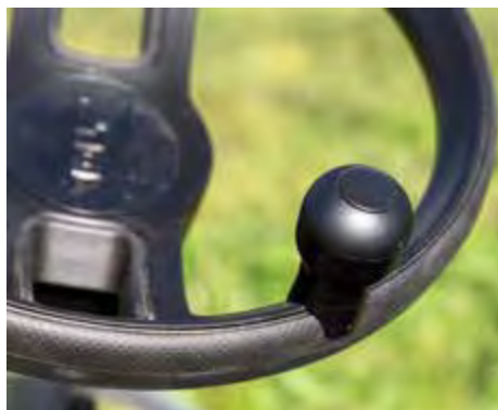
+ KURBEL: Der Stiga Frontmäher ist mit Knauf schneller lenkbar.
