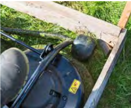
- ABSTAND: Bei McCulloch und Gardol verhindern Rollen ein enges Ausmähen.
