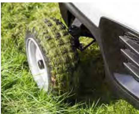
— TRAKTION: Bei Gardol setzt sich (feuchter) Grasschnitt ins Profil der Reifen.
