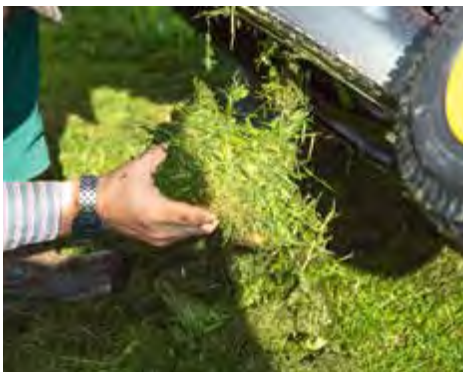
— BLOCKIERT: Ist der Fangkorb zu voll, kann das Mähwerk verstopfen ( Wolf ).
